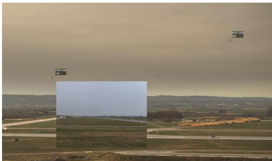
Obrázek 8 Výstup z PTZ (dole) a sekundárního radaru (nahore) na OTW. Zdroj: [4]
