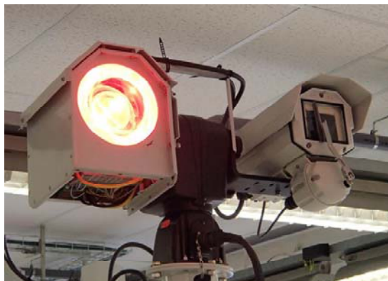
Obrázek 7 Světelné dělo napojené na PTZ kameru. Zdroj: [4]. Kamerový kryt. Zdroj: [4]
