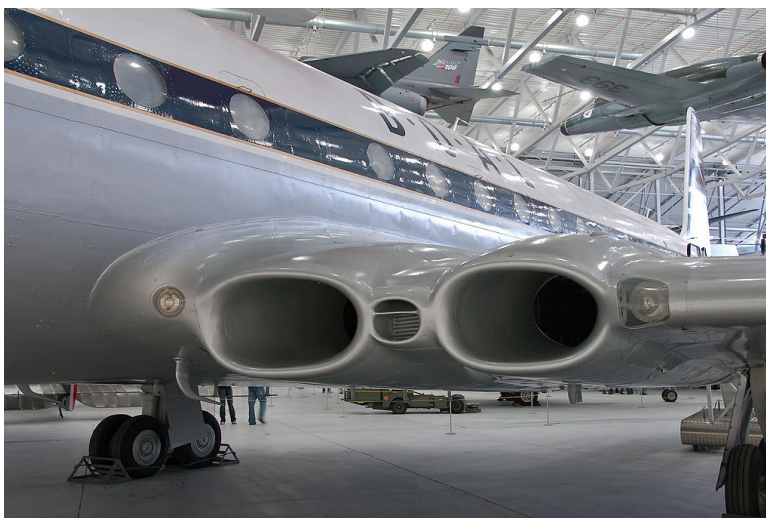
Obr. 2: Vonkajšie vstupné ústrojenstvo
