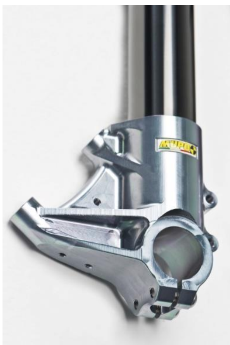
Obrázek 35 - Příklad moderního držáku předního třmenu [19]
