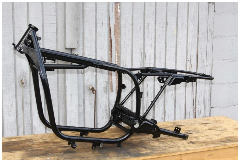
Obrázek 5 - Rozdvojený uzavřený rám BMW R90/6 (1974) [10]
