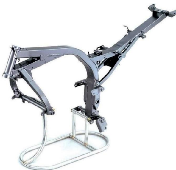
Obrázek 6 - Páteřový uzavřený rám Honda CB900F Hornet (2002) [11]
