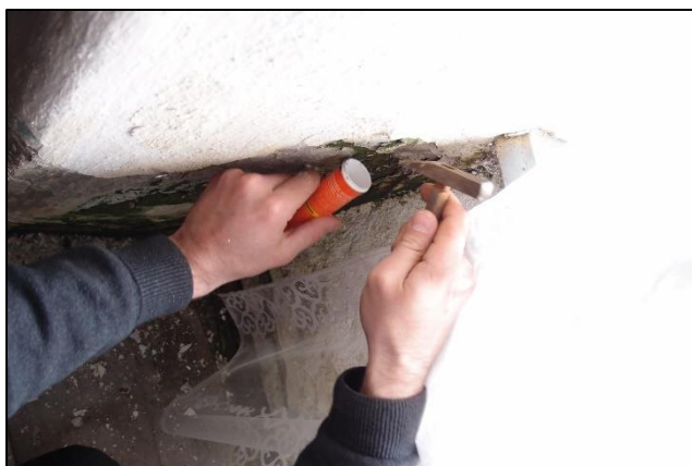
obr. 24 – Odběr vzorku v ostění okna v JV stěně místnosti 1.08
