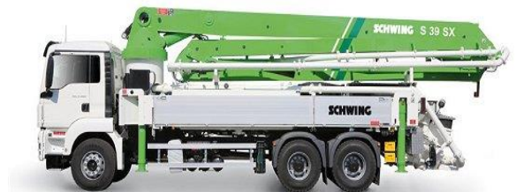
Obr. 9 – Autočerpadlo SCHWING S 39SX [4]
