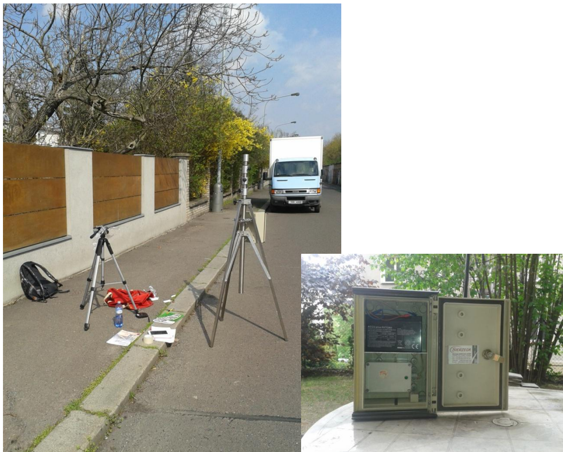
Obrázek 6.1 Zkoušení statického radaru Sierzega + pohled na přístroj
