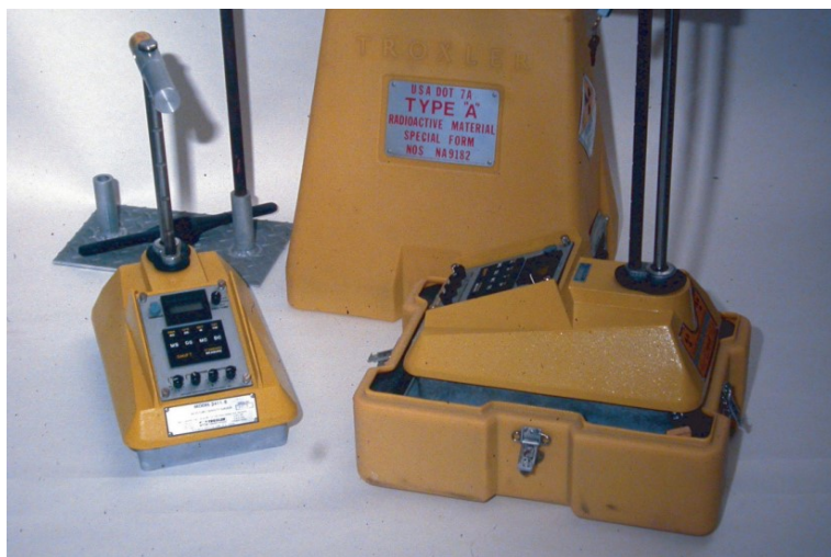
Obr. 1. 5 Radiometrická souprava Troxler model 3411 (Zdroj: http://www.sinz.cz/archivdocssi-2005-03-175-178.pdf )
