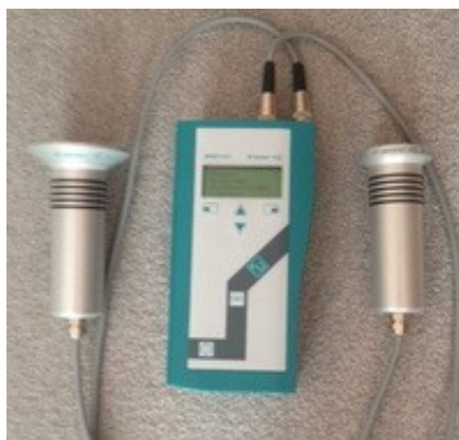
Obr. 1. 2 Mikrovlnný měřicí přístroj MOIST-210 (Zdroj: httpwww.sanace-zdiva-praha.czmereni-vlhkosti-zdiva )
