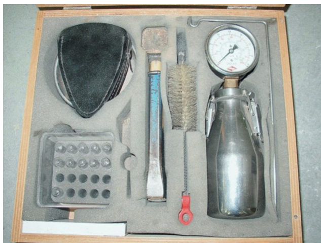
Obr. 1. 1 Měřicí soustava přístroje CM pro metodu karbidu vápníku (Zdroj: httpwww.estav.czcz1839.metody-a-technicke-prostredky-pro-sanaci-vlhkeho-zdiva )
