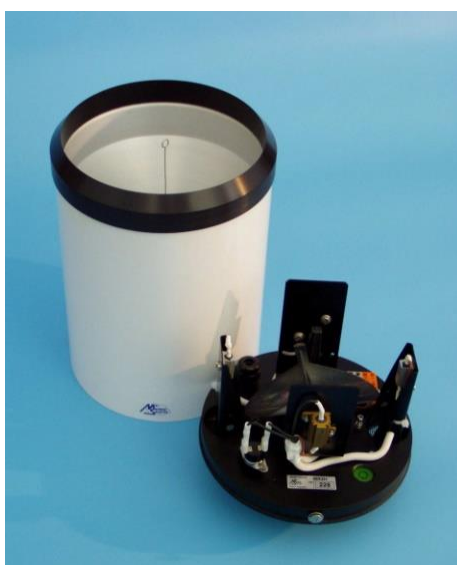
Obr. 1: Srážkoměr s překlápěcím člunkem MR2H se záchytnou plochou 200 cm 2 . Vyobrazení převzato z manuálu Meteoservis [3].
