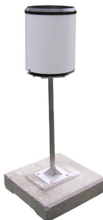
Obr. 5: Překlopný srážkoměr SR03 Fiedler se zachytnou plochou 500 cm 2 . Vyobrazení převzato z manuálu Fiedler [4].
