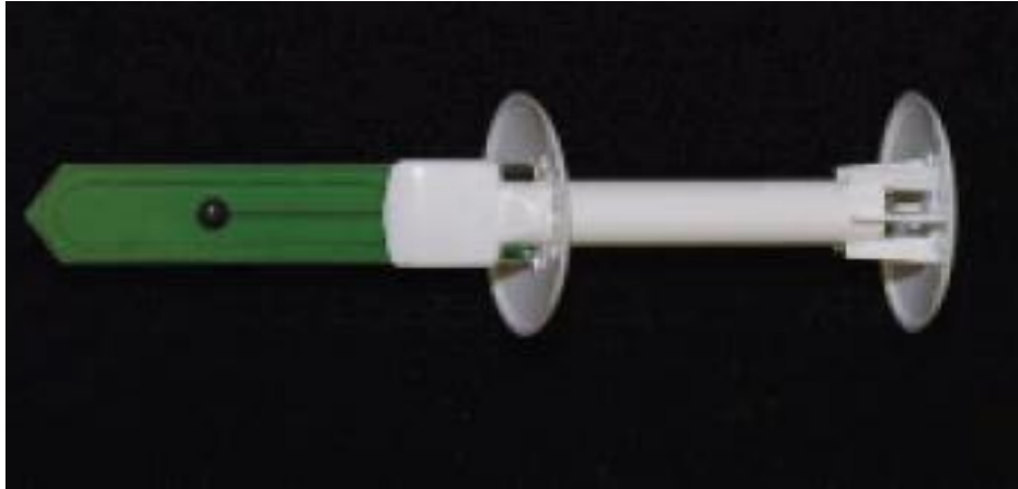
Obr. 7 TMS stanice. Vyobrazení převzato z webových stránek výrobce TOMST s. r. o. [20].
