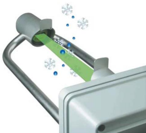
Obr. 4: Princip měření laserovým detektorem srážek. Vyobrazení převzato z manuálu výrobce Thies Clima [10].
