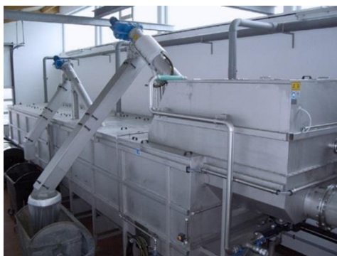
Obr. 10 - Integrované hrubé predčistenie typu Ro [15]
