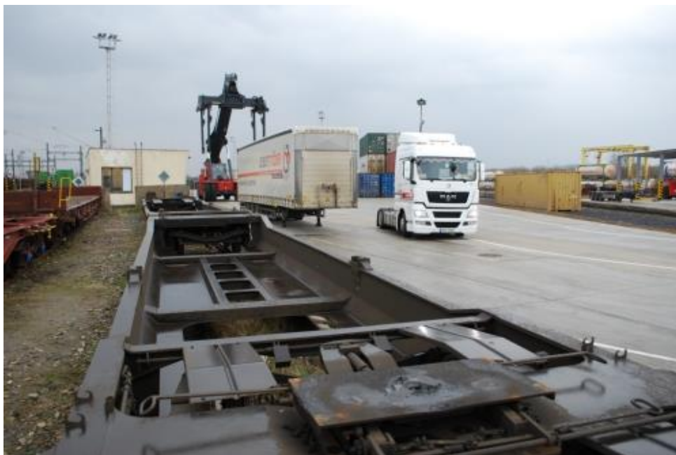
Obrázek 10 – Kapsový vůz pro přepravu návěsů, terminál ČD DUSS Lovosice
