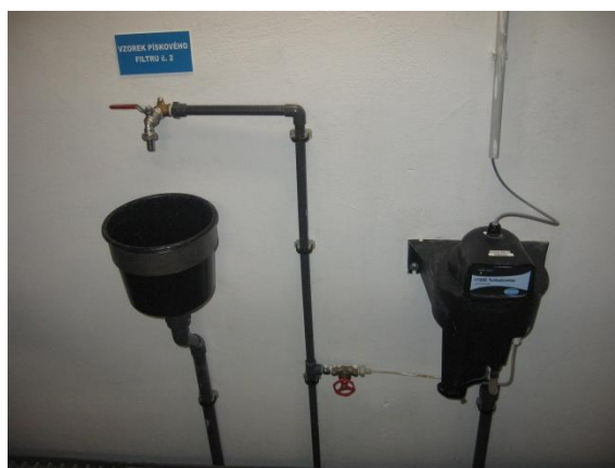
Obrázek 41: Odběr vzorku odsazené vody sedimentací, turbidimetr pro měření zákalu za sedimentací
