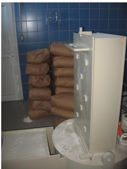
Obrázek 15: Pytle s práškovým síranem hlinitým a výklopný zásobník
