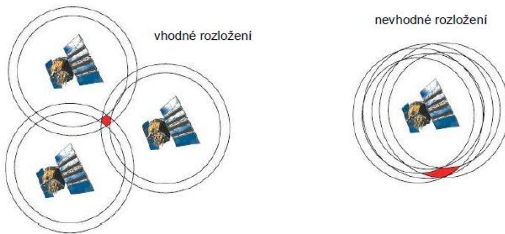
Obrázek 1: Dopad geometrického rozložení satelitů. [33]
