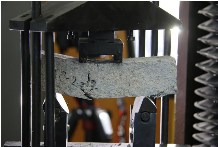
Obrázek 7: Zkušební těleso bez optimalizování množství cementu, vody a mikroplniva.
