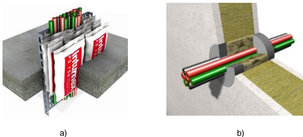
Obr. 9 – Rozebíratelné požární ucpávky: a) kabely těsněné požárními sáčky [14], b) kabely těsněné požárními zátkami [14]
