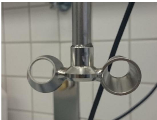
Obrázek 22: Míchadlo Visco-jet – typ: dva kužele s otevřenými konci
