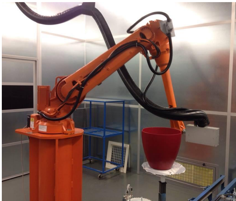
Obr. 19 Průmyslový robot IRB 2600 před vytvrzením laku na květináči
