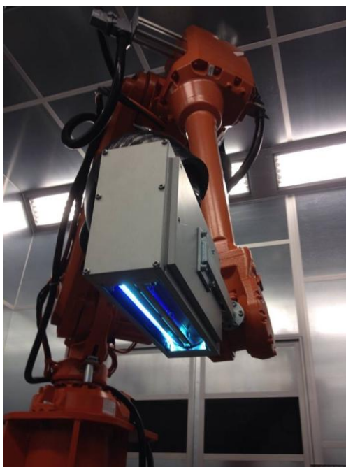
Obr. 17 UV lampa nesená robotem IRB 2600
