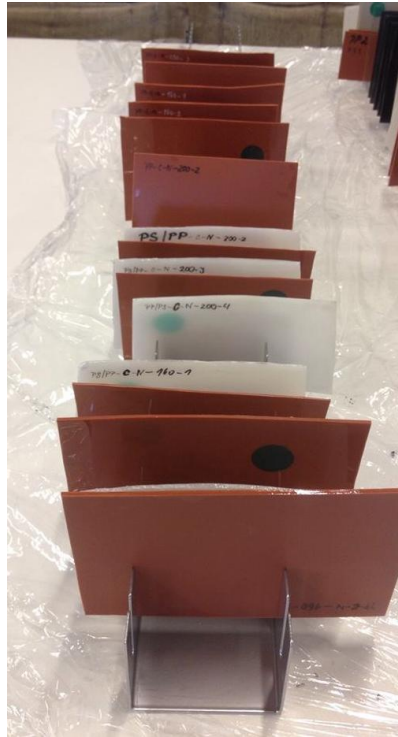
Obr. 9 Plastové vzorky pro volbu parametrů vytvrzení
