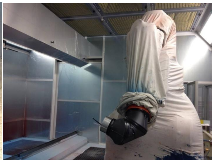
Obr. 15 Lakovací robot bez koncového efektoru
