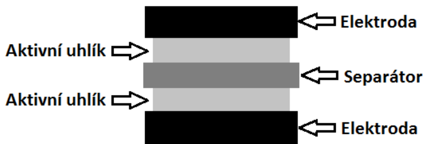
Obrázek č.5 – schéma superkapacitoru
