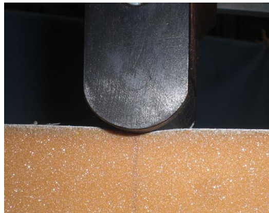
Obr. 15: Vmáčknutí zatěžovacího prvku do nosníku
