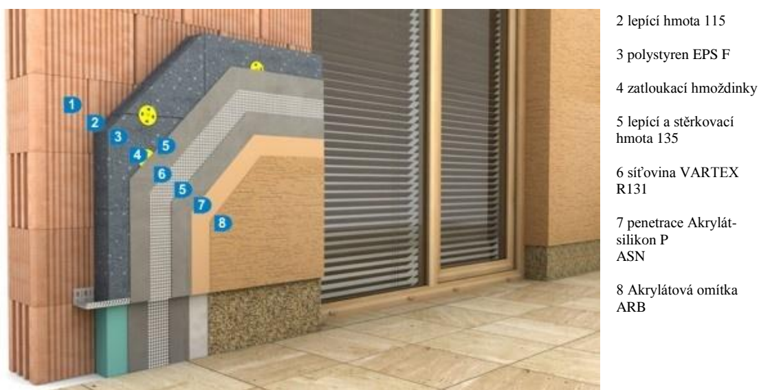
Obr. 4.2 Konstrukce zateplovacího systému Cemix THERM P BASIC SILVER [10]
