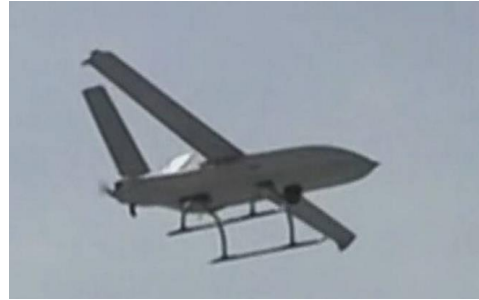
Obr. 10: Shahed 123 (IR), letoun s klasickou ližinovou konstrukcí [19]
