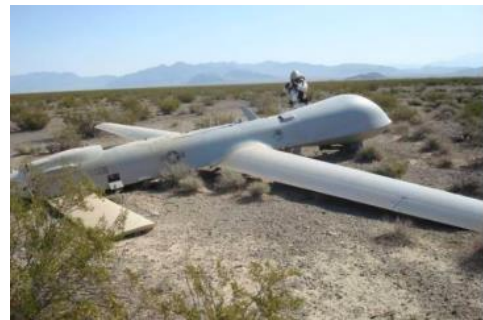
Obr. 8: MQ-1 Predator (USA), díky precizně provedenému nouzovému přistání po technické závadě nedošlo k rozsáhlým poškozením letounu [16]
