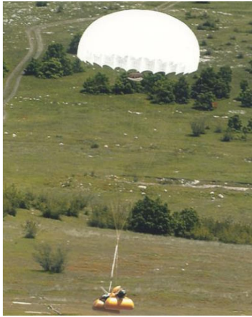
Obr. 23: Canadair CL-89 (CAN+GB+DE), představitel současného využití padáku a airbagů pro přistání [29]
