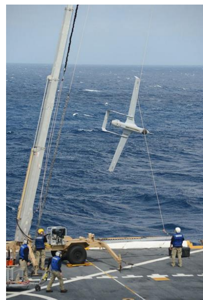
Obr. 36: RQ-21 Blackjack (USA), po zachycení lana na zařízení zvaném SkyHook umístěném na palubě lodi [42]
