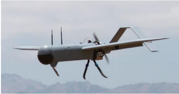
Obr. 9: Super Bat DA-50 (USA), letoun s netradiční ližinovou konstrukcí [18]
