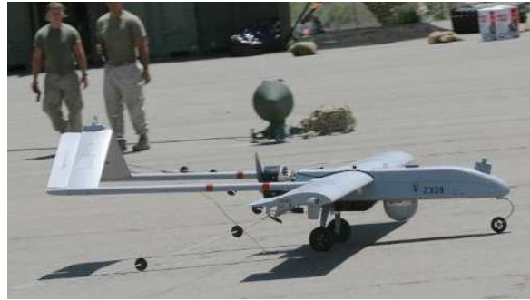
Obr. 4: RQ-7B Shadow 200 (USA) po přistání s ještě zachyceným zpomalovacím lanem [11]
