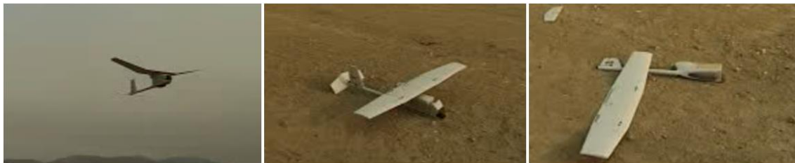
1. → 2. → 3. Obr. 28: Raven (USA), letoun zachycen při přistání, kdy dochází k jeho rozložení na jednotlivé moduly [34]
