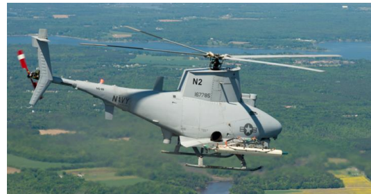
Obr. 15: MQ-8B Fire Scout (USA), kategorie bezpilotní vrtulník [25]
