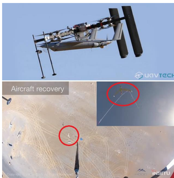
Obr. 35: ScanEagle (USA), letoun ve spolupráci se systémem FLARES, který letoun vynáší do vzduchu a následně drží lano, o které se stroj zachytí [41]
