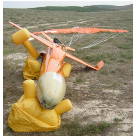
Obr. 31: Mirach 100/5 (IT), stroj po dosednutí na zem, během něhož bylo poškozeno levé křídlo vlivem nesprávné funkce airbagu [36]
