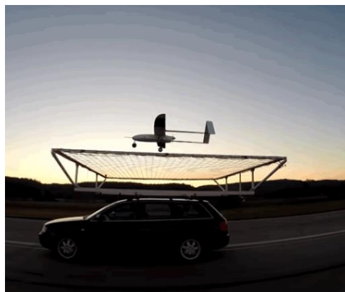
Obr. 39: Penguin B UAV (LV), German Aerospace Center předvádí způsob autonomního přistání dronu na pohybující se vozidlo [46]
