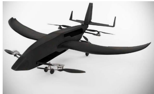
Obr. 13: Krossblade SkyProwler (USA), VTOL charakteristika dosažena pomocí výklopných svislých rotorů a energetická úspora pomocí vodorovných tlačných rotorů [23]
