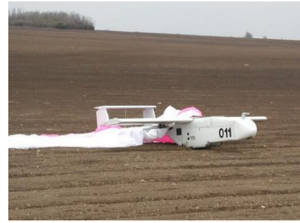
Obr. 24: Sojka III (ČR), představitel využití padáku jako 1 z 2 možností (2. možnost je přistání na spodní část trupu [30])
