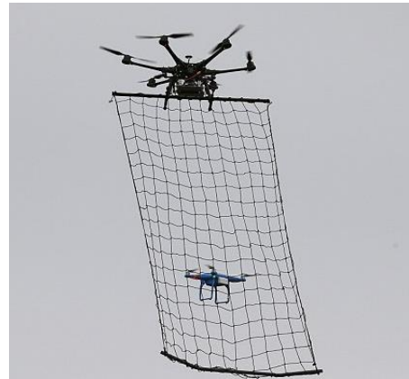
Obr. 38: Japonský policejní dron opatřený sítí k odchytu podezřelých dronů [45]
