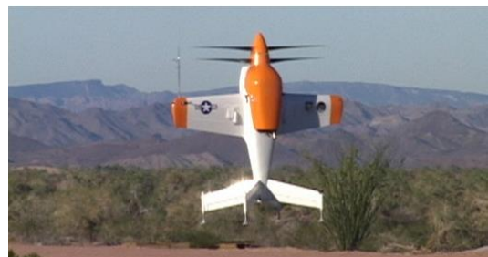
Obr. 17: AeroVironment SkyTote (USA), kategorie Tailsitter [27]
