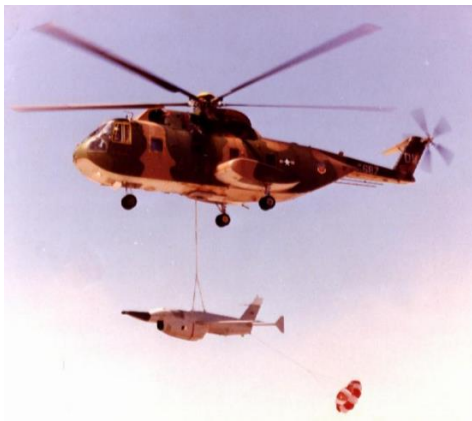
Obr. 37: AQM-34 Ryan Firebee (USA), MARS metoda během které je UAV zachyceno vrtulníkem při svém sestupu na padáku [44]
