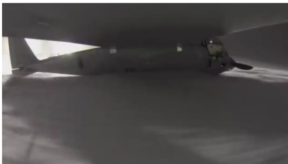
Obr. 7: Arcturus T-20 (USA), letoun přistávající na sněhu, vrtule zastavena v poloze, ve které nedojde ke kontaktu se zemí [15]
