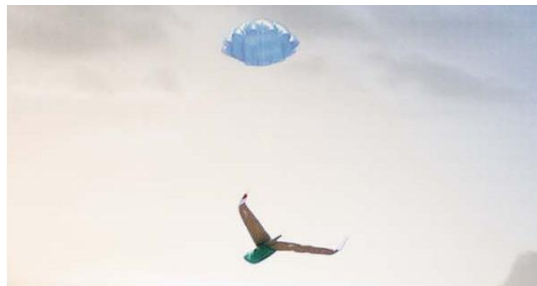
Obr. 22: Orbiter Mini UAV (IL), představitel využití padáku jako primární způsob přistání [28]
