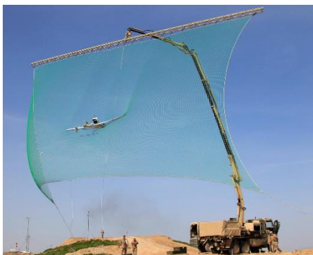
Obr. 33: EMT Luna X-2000 (DE), při zachycení na mobilním záchytném zařízení [38]
