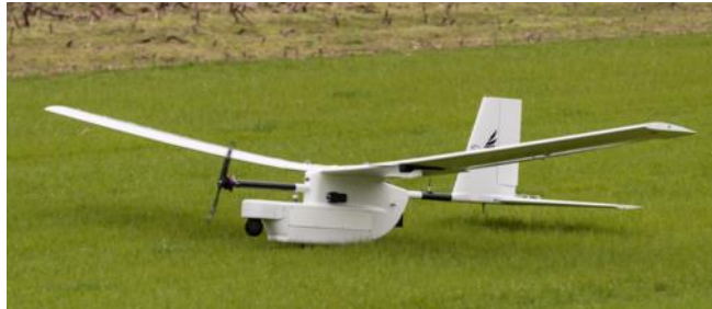
Obr. 6: Talon 240 (USA), nesené přístroje i vrtule jsou umístěny tak, aby při přistání nedošlo ke kontaktu se zemí [14]
