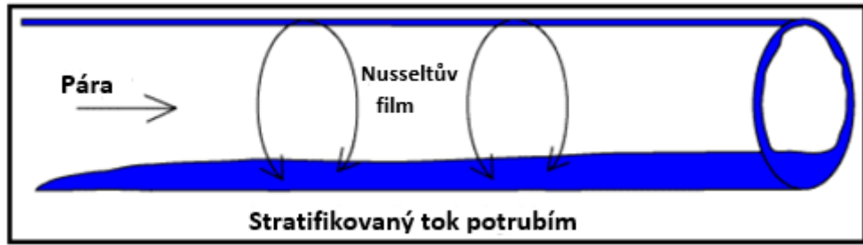
Obr. 11: Stratifikovaný tok potrubím [4]
