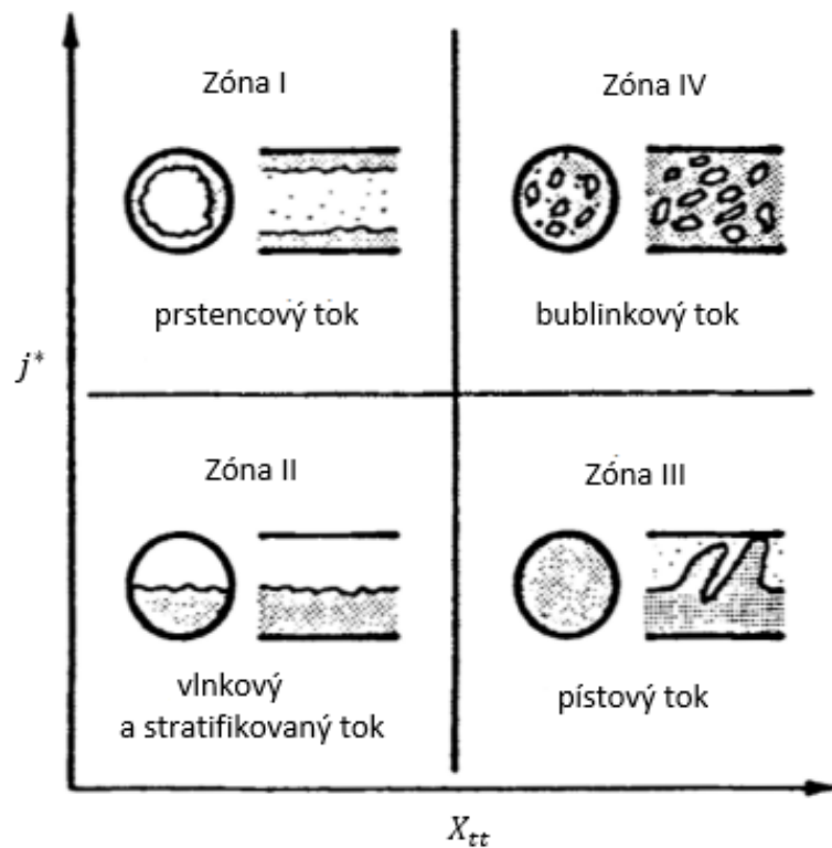
Obr. 8: Schématický diagram režimů toků uvnitř horizontální trubky [8]
