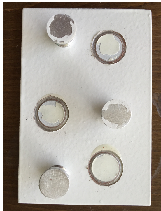
Obr. 35: Výsledek odtrhové zkoušky vz. 0103.5
