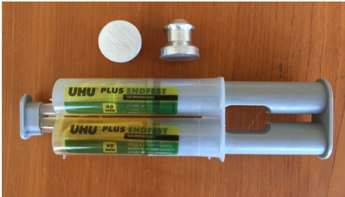
Obr. 24: Dvousložkové epoxidové lepidlo a odtrhové hlavice
