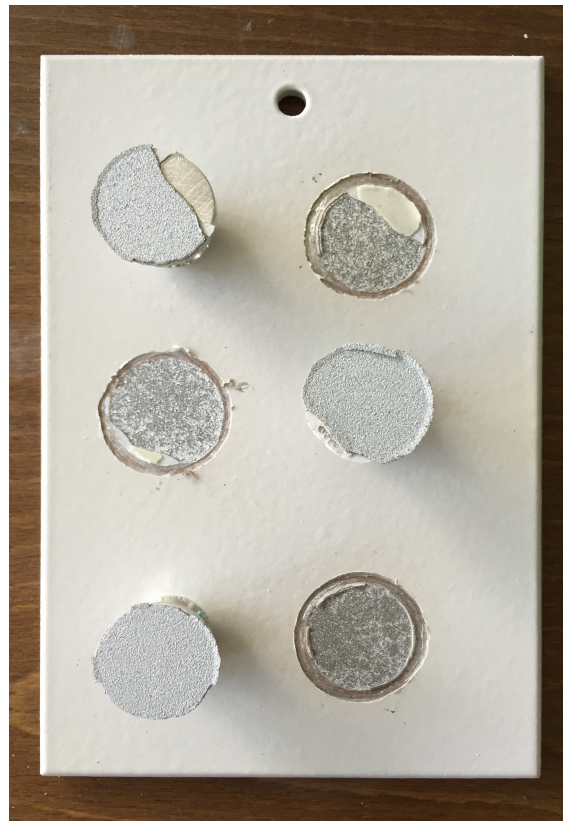
Obr. 33: Výsledek odtrhové zkoušky vz. 0127.2
