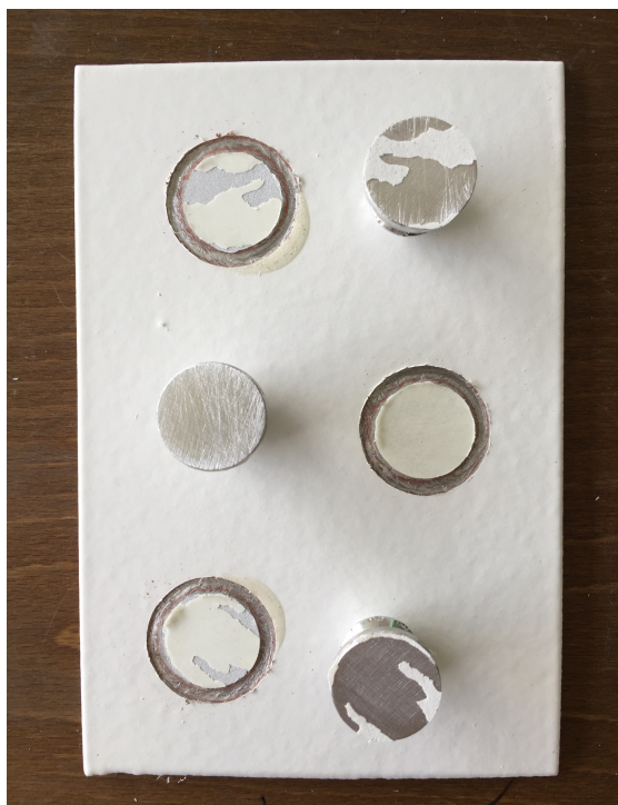
Obr. 34: Výsledek odtrhové zkoušky vz. 0105.4
