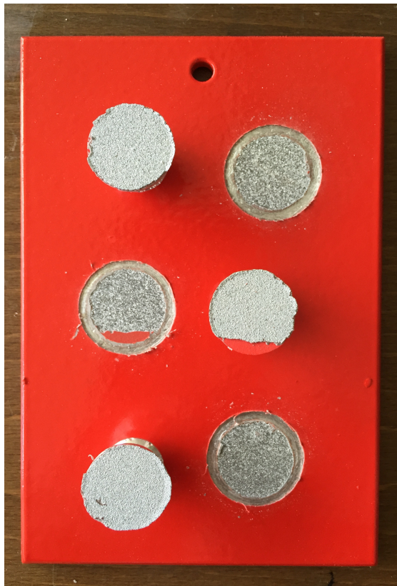
Obr. 32: Výsledek odtrhové zkoušky vz. 0126.1
