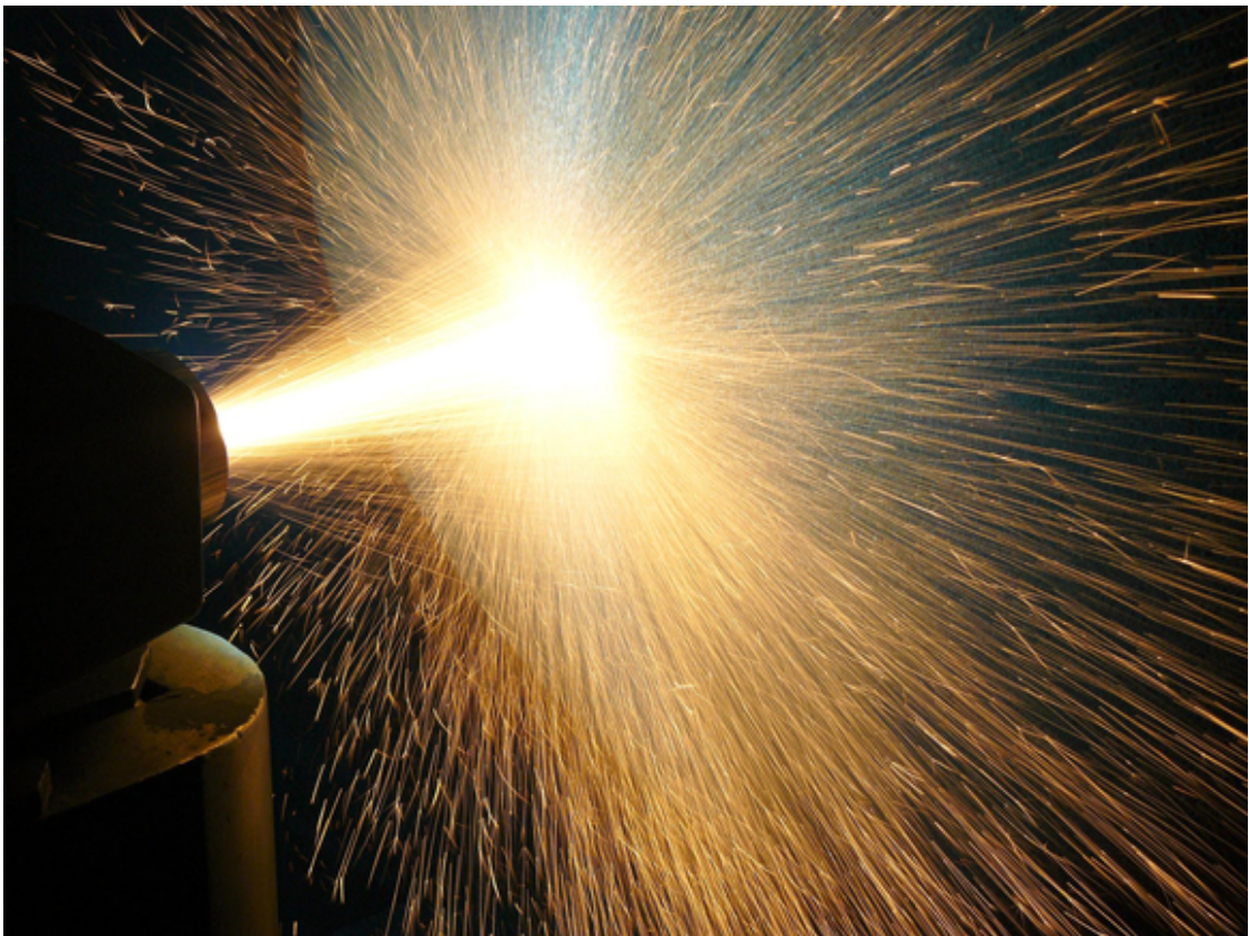
Obr. 15: Nástřik elektrickým obloukem [15]
