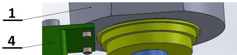
Obr. 25 - Montáž horního bloku šrouby do vřetene
