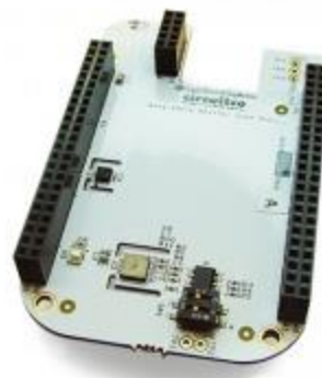
Obrázek 3.5.4 Weather Cape (z: http://elinux.org/CircuitCo:BeagleBone_Weather )
