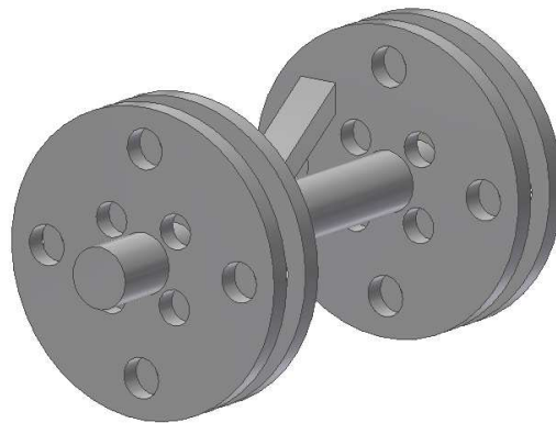
Obrázek 29 – návrh rotoru s otvory ve vyvažovacích rovinách
