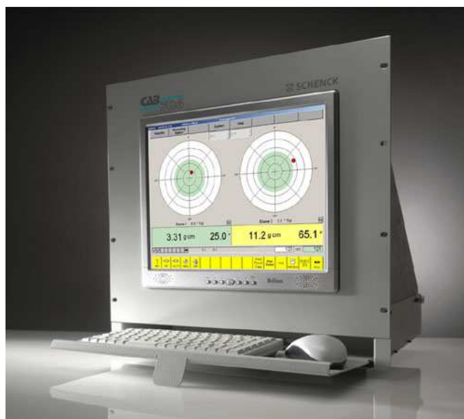
Obrázek 23 – parametry vývažků určené počítačem (catalog.schenck-usa.com/products)
