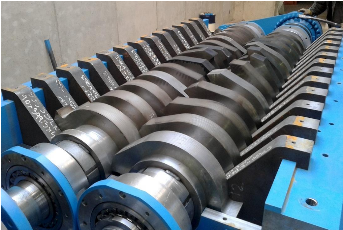
obr. 1.6.2.b: Pracovní prostor dvouhřídelového drtiče [2]
