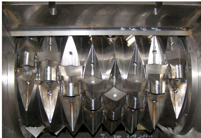
obr. 1.6.1.: Rotor s břity jednohřídelového drtiče [2]
