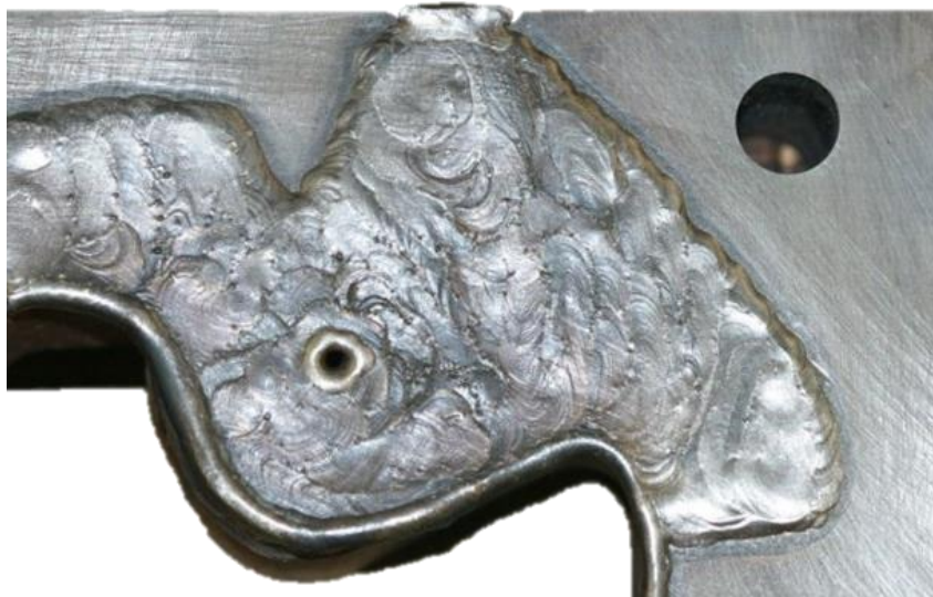
Obrázek 4-4 - Ruční tvrdokovový návar [27]
