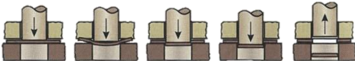
Obrázek 3-1 - Stříhání pomocí stříhadla [15]
