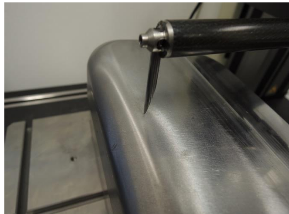
Obrázek 5-4 - Měření pomocí konturografu
