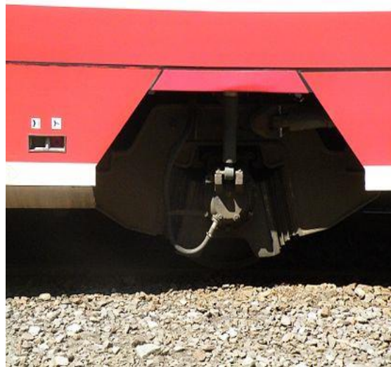
Obr. 1.9 Podvozek motorového vozu 213M
