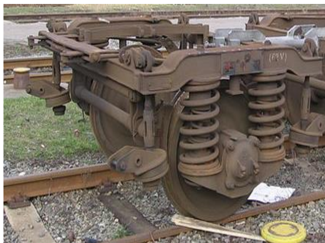
Obr. 1.4 podvozek VÚKV typ 8-807.8.
