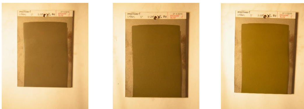
Obr. 10 Ukázka změny barvy po teplotním zatížení 50°C (Otryskaná žlutá), Vlevo maximální teplota, uprostřed teplota přechodu 35°C, vpravo teplota okolí 25°C
