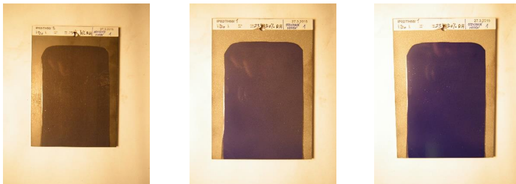
Obr. 9 Ukázka změny barvy po teplotním zatížení 50°C (Neotrysk. modrá), Vlevo maximální teplota, uprostřed teplota přechodu 35°C, vpravo teplota okolí 25°C
