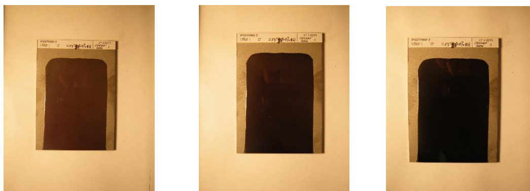
Obr. 11 Ukázka změny barvy po teplotním zatížení 70°C (Otryskaná černá), Vlevo maximální teplota, uprostřed teplota přechodu 60°C, vpravo teplota okolí 25°C
