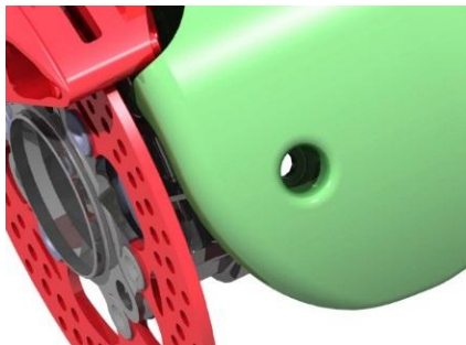
Obr. 30: Upevnění k těhlici
