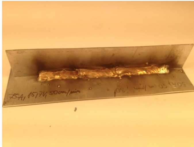
Obr.27 – MIG spájkovanie, vidno nerovnomernosť spájkovanej húsenice
