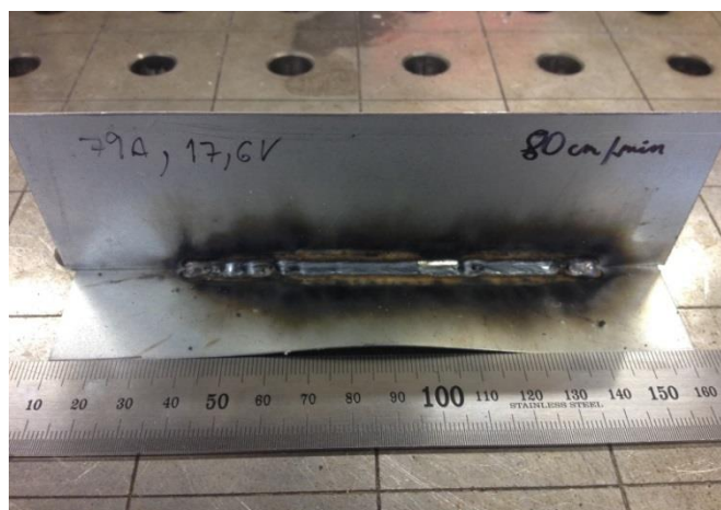
Obr.25 – pohľad na nepoužiteľný zvar a deformáciu spodného plechu
