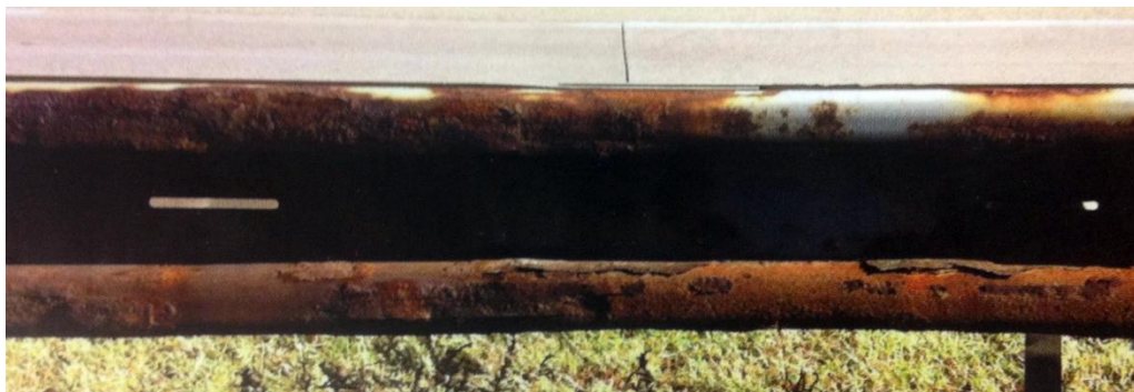
Obr.1 – príklad elektrochemickej korózie [1]
