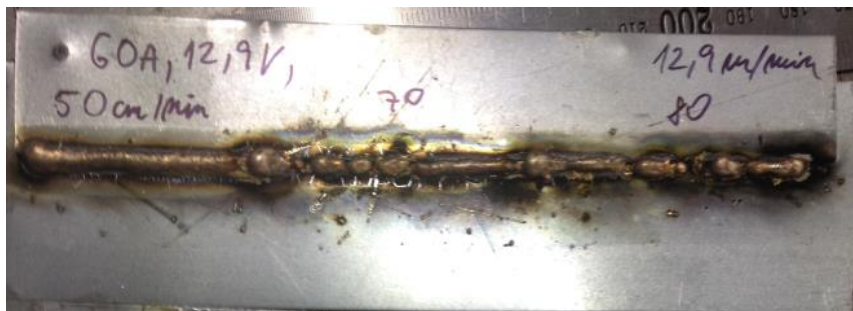
Obr.21 – rozdiely v kvalite spoja v závislosti na rýchlosti MIG spájkovania
