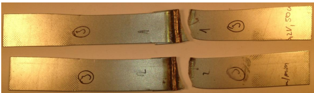
Obr.32 – vzorky preplátovaného spoja po ťahovej skúške
