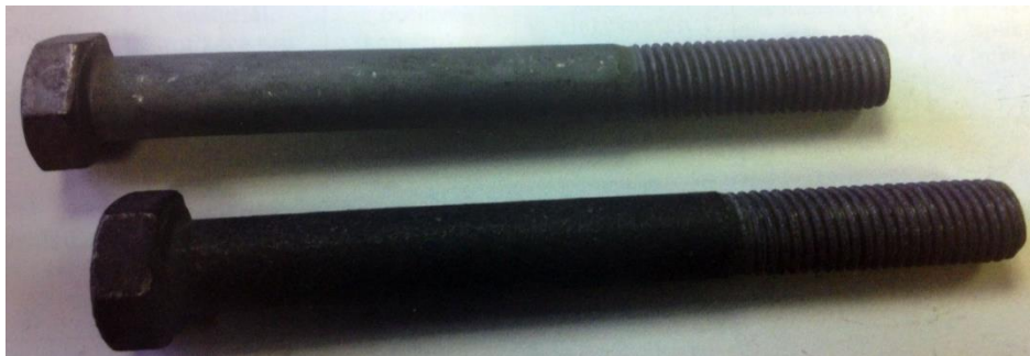
Obr.3 – príklad naniesenia zinku na súčast' sherardovaním [1]
