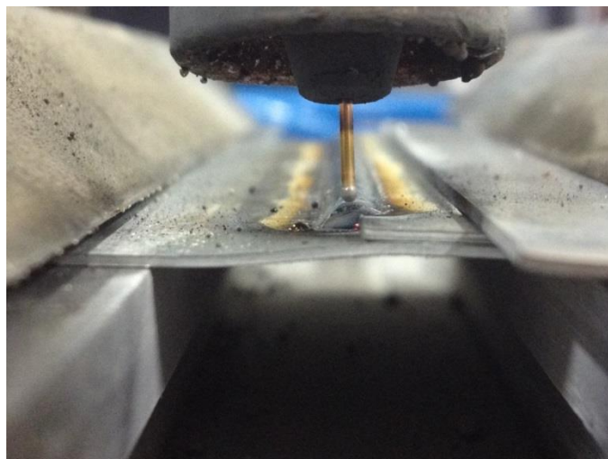
Obr.16 - Detailný záber na systém upnutia – preplátovaný zvar, vidno tepelnú deformáciu, ktorá vznikla pri MAG zváraní.
