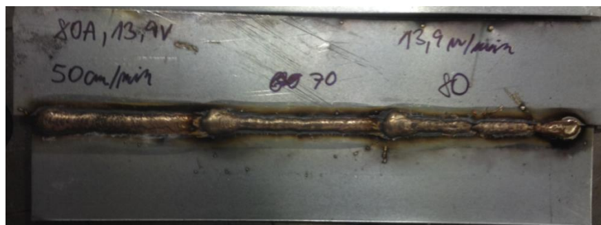
Obr.22 – rozdiely v roztekavosti spájky pri meniacej sa v a konštantnom I a U
