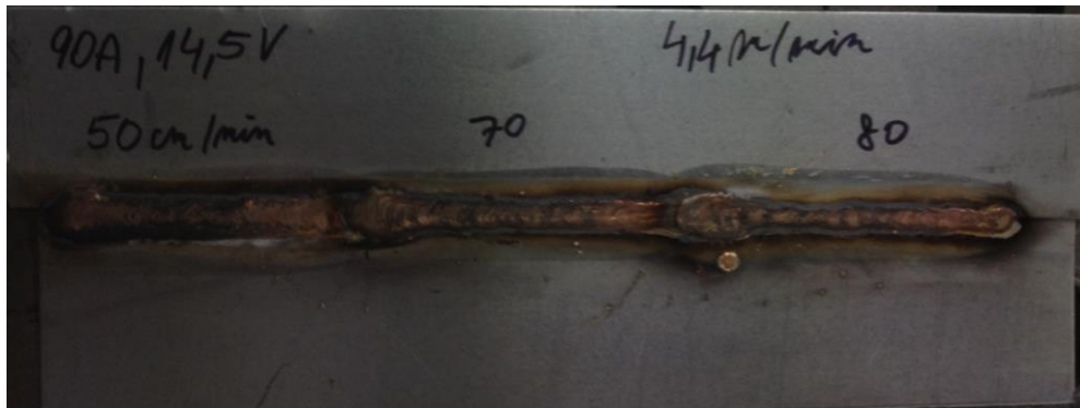
Obr.23 – rôzne šírky spojov v závislosti na rýchlosti MIG spájkovania
