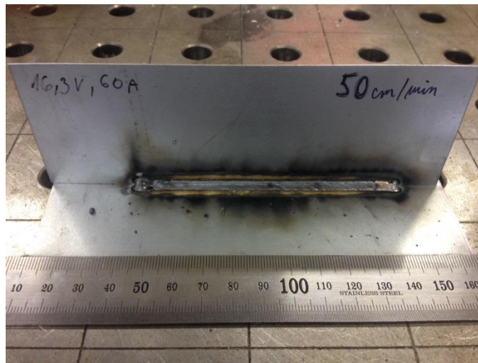
Obr.24 – zodpovedajúci kútový zvar vytvorený zváraním MAG
