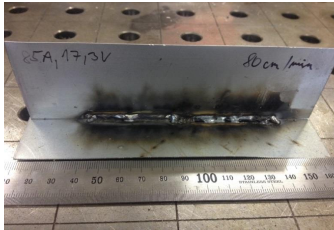
Obr.26 – kútový zvar – vidno nedostatky ako prepal materiálu póry atď.
