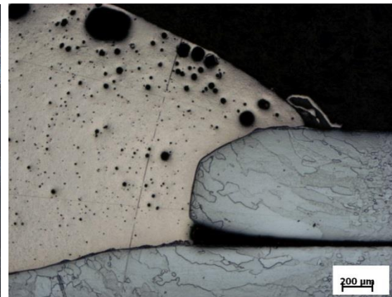
Obr.38 – makroštruktúra spájkovaného spoja Obr.39 – prechod zvarový kov – ZM, zv. 25x
