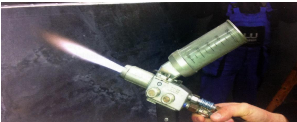
Obr.4 – Metalizačná pištoľ pre žiarové striekanie v práškovom prevedení je vhodná na opravy povlakov žiarového zinku naneseného ponorom do roztaveného zinku [1]
