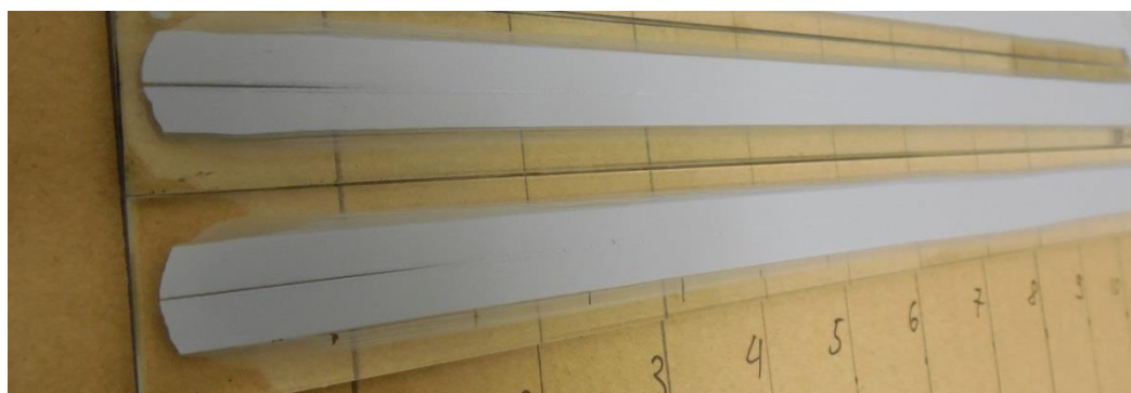
Obr.5.4 - Stopa od jehly v nátěru na vzorcích EPAX S2318 s tužidlem S7308
