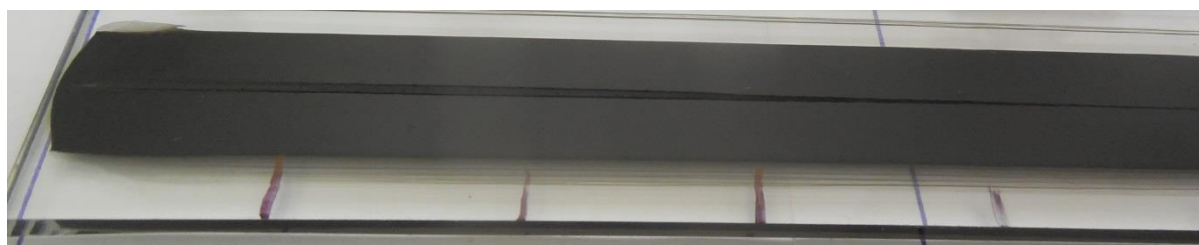
Obr. 5.5 - Různé stavy zaschnutí na vzorku EPAX S2339 s tužidlem S7307
