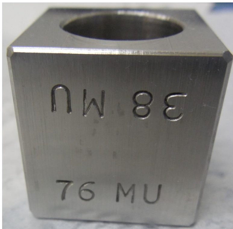
Obr. 5.3 - Aplikátor pro tloušťky 38 \mu\text{m} nebo 76 \mu\text{m} od výrobce TQC B.V.
