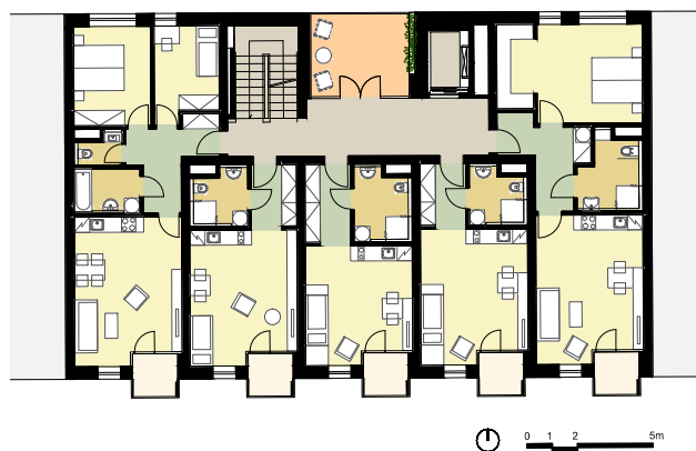
Obr. 3.2 - 16 Návrh vzorového seniorského bydlení, vícepodlažní varianta, půdorys 4.nadzemního podlaží, FA ČVUT, 2015
