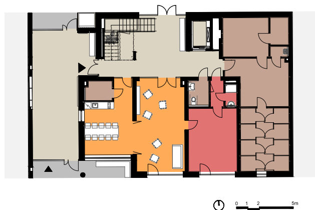
Obr. 3.2 - 14 Návrh vzorového seniorského bydlení, vícepodlažní varianta, půdorys 1.nadzemního podlaží, FA ČVUT, 2015
