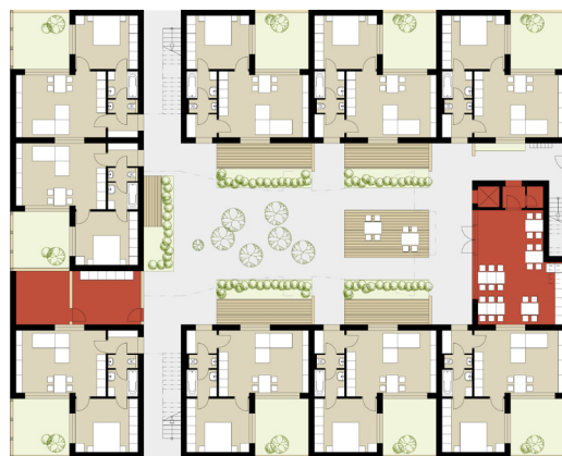
Obr. 3.3 - 19 Půdorysné schéma 1.nadzemního podlaží modelového řešení komunitního bydlení s vyznačením společenských prostorů, varianta městská pavlač
