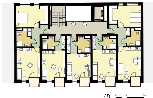
Obr. 3.2 - 15 Návrh vzorového seniorského bydlení, vícepodlažní varianta, půdorys 3.nadzemního podlaží, FA ČVUT, 2015
