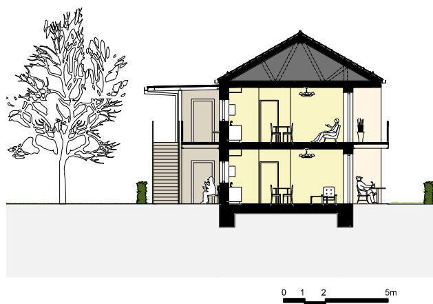
Obr. 3.2 - 13 Návrh vzorového seniorského bydlení, nízkopodlažní varianta, příčný řez s pavlačí, FA ČVUT, 2015
