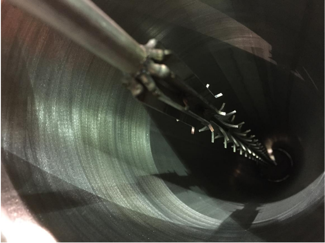
Obr. 3.1 Detail elektrod trubkového mokrého odlučovače (převzato z [10])
