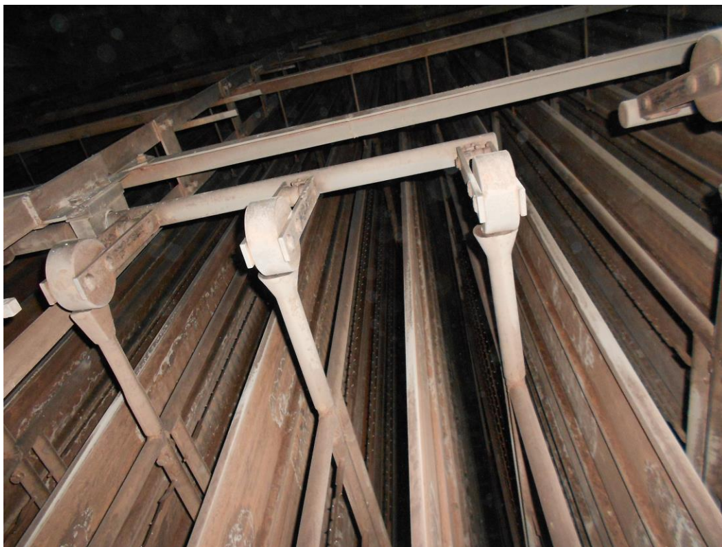
Obr. 3.9 Detail oklepávacích kladiv rámu vysokonapět'ových elektrod (vlastní fotografie s vědomím provozovatele)
