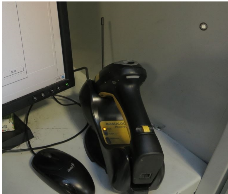
Obr. 36: bezdrátové čtecí zařízení Datalogic POWERSCAN M8300 instalované na konečné výrobní stanici montážní linky DQ200
