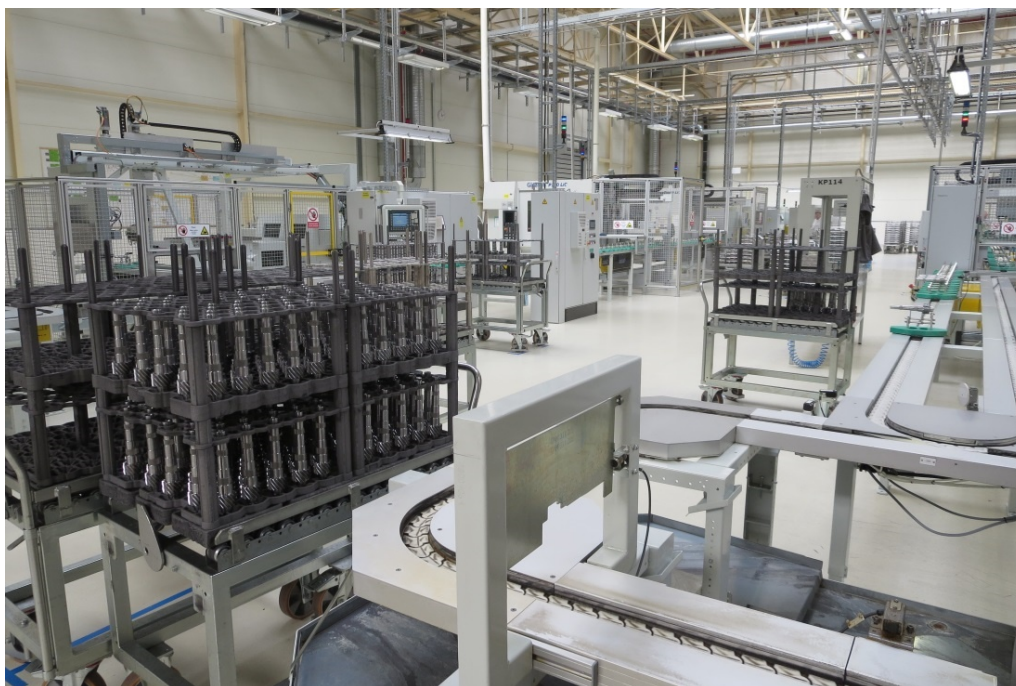
Obr. 7: kalírenské vsázky na vykládce dílů z poslední fáze „měkkého“ obrábění
