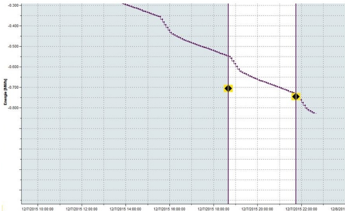
Obr. 17: graf kumulativní spotřeby topné pece BK7 při automatickém provozu, zdroj Fluke Energy logger
