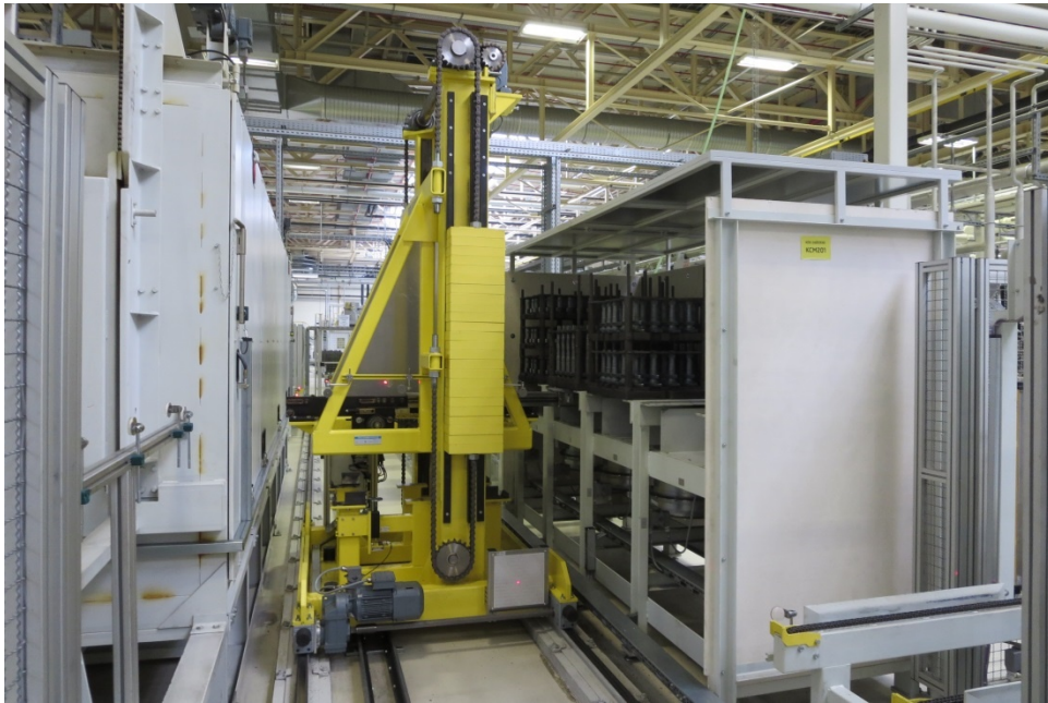
Obr. 3: transportní zařízení ETS u odkládacího zásobníku
