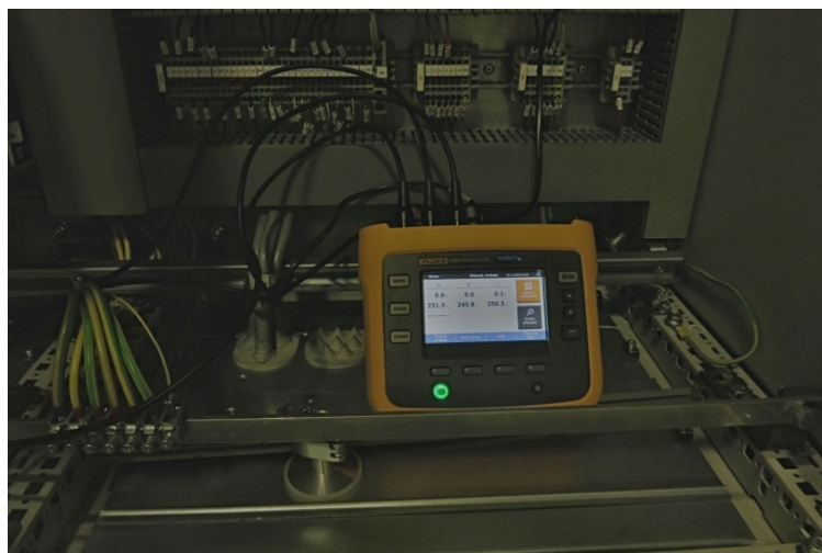
Obr. 11: měřicí přístroj FLUKE 1730 Energy logger
