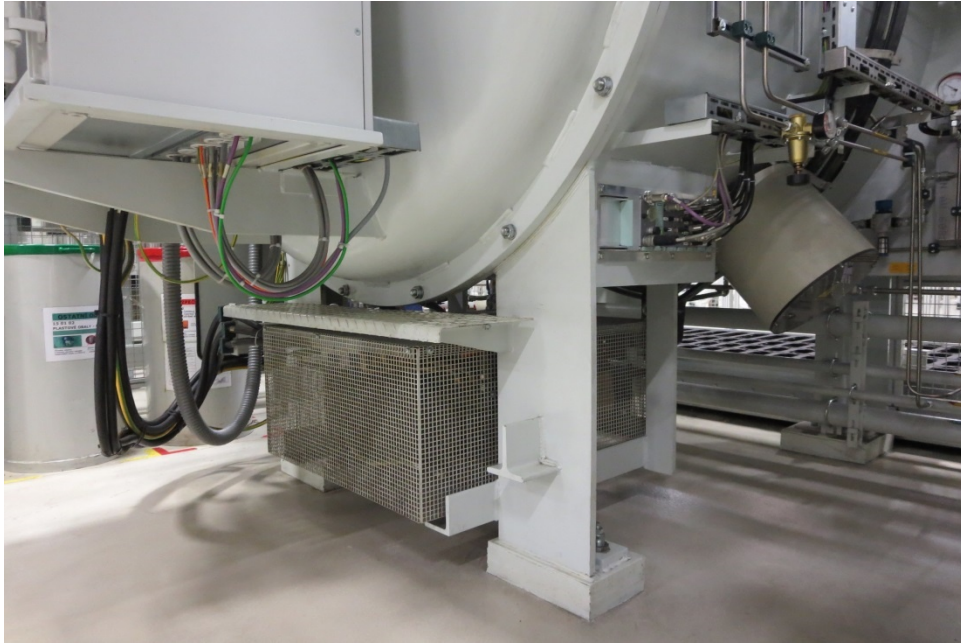
Obr. 5: umístění transformátoru topných spirál pod pecí BK
