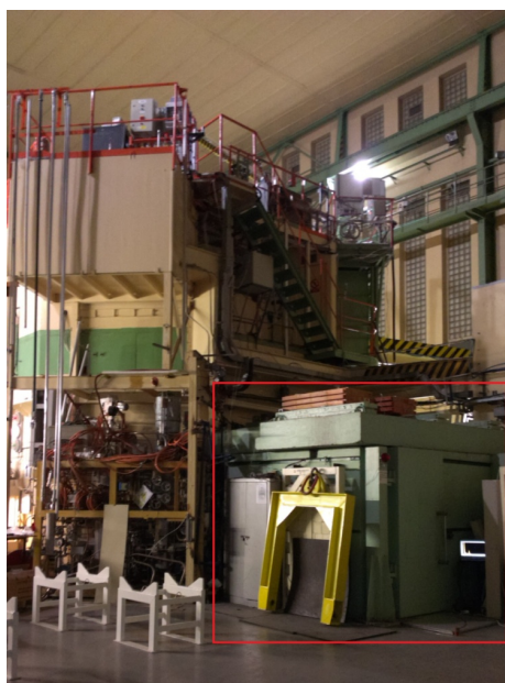
Obr. 23: Kobka BNCT (vyznačená v červeném rámu) u reaktoru LVR-15.
