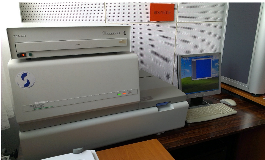
Obr. 27: Zařízení FUJIFILM BAS – 1800 pro poexpoziční zpracování výsledků z neutronové zobrazovací desky.
