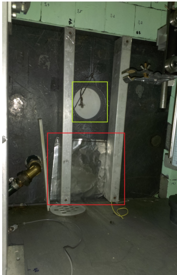
Obr. 26: Neutronová zobrazovací deska (v červeném rámu) umístěná ve výchozí experimentální pozici pod ústím neutronového svazku (zelený rám).
