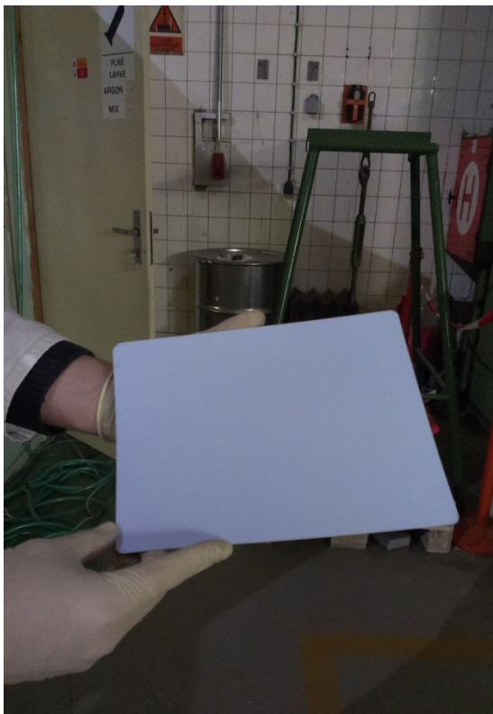
Obr. 21: Neutronová zobrazovací deska použitá při měření.
