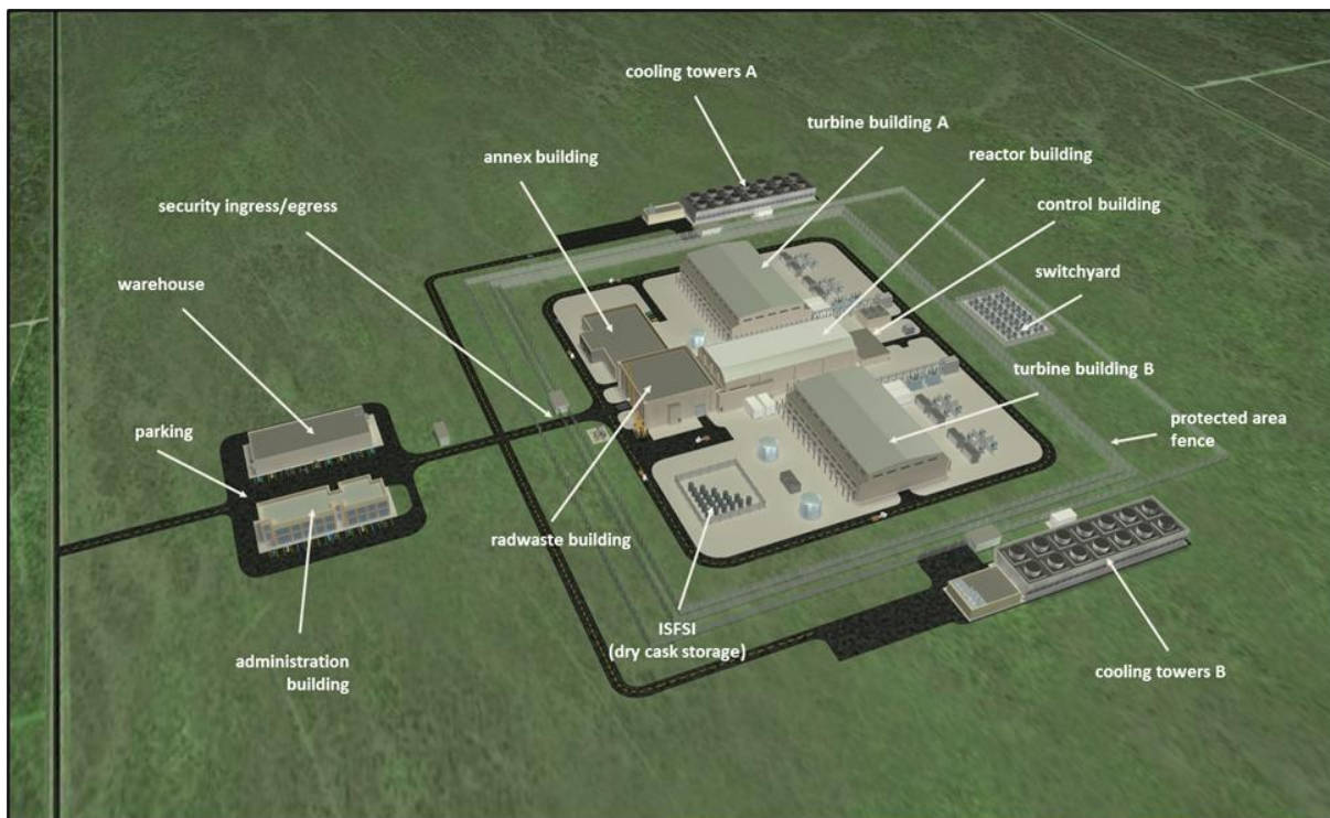
Obr. 11: Uspořádání bloku s 12 moduly reaktoru NuScale [Nus15]
