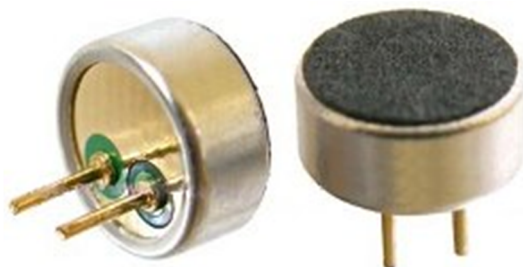
Obrázek 3.1: Měřený mikrofón MCE-2500 , převzato z ges.cz
