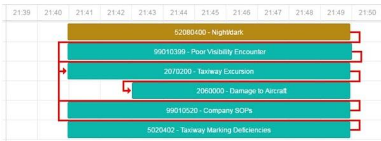
Obrázek č. 10 - Rozbor události ulomení podvozkového kola
