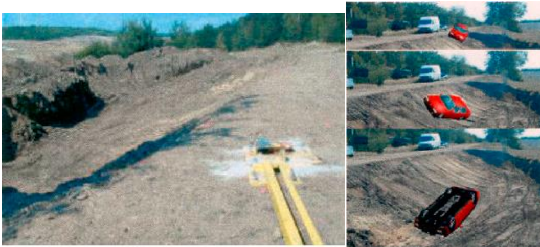
Obrázek 12 - embankment roll-over test v exteriéru (zdroj: [1])
