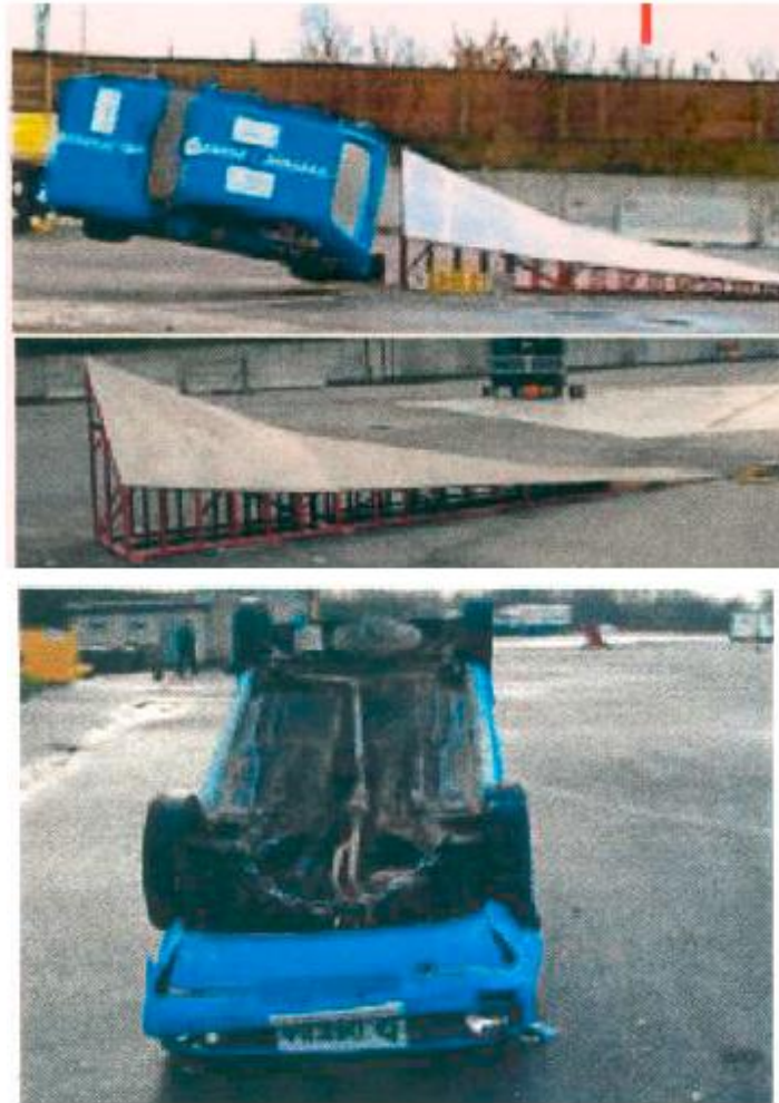
Obrázek 16 - rampa se zakřiveným povrchem (zdroj: [1])
