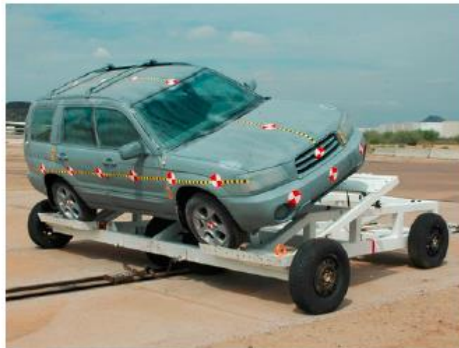
Obrázek 10 - plošina s testovacím vozidlem při dolly roll-over testu (zdroj: [6])
