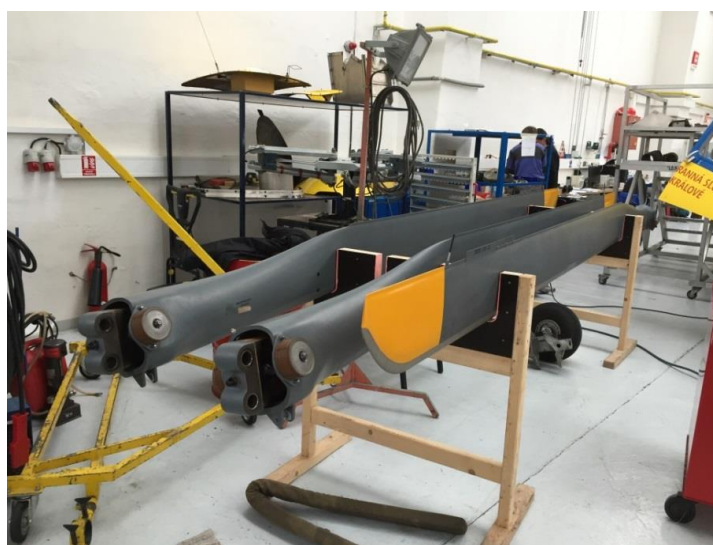
Obr. 36 Demontované listy hlavního rotoru
