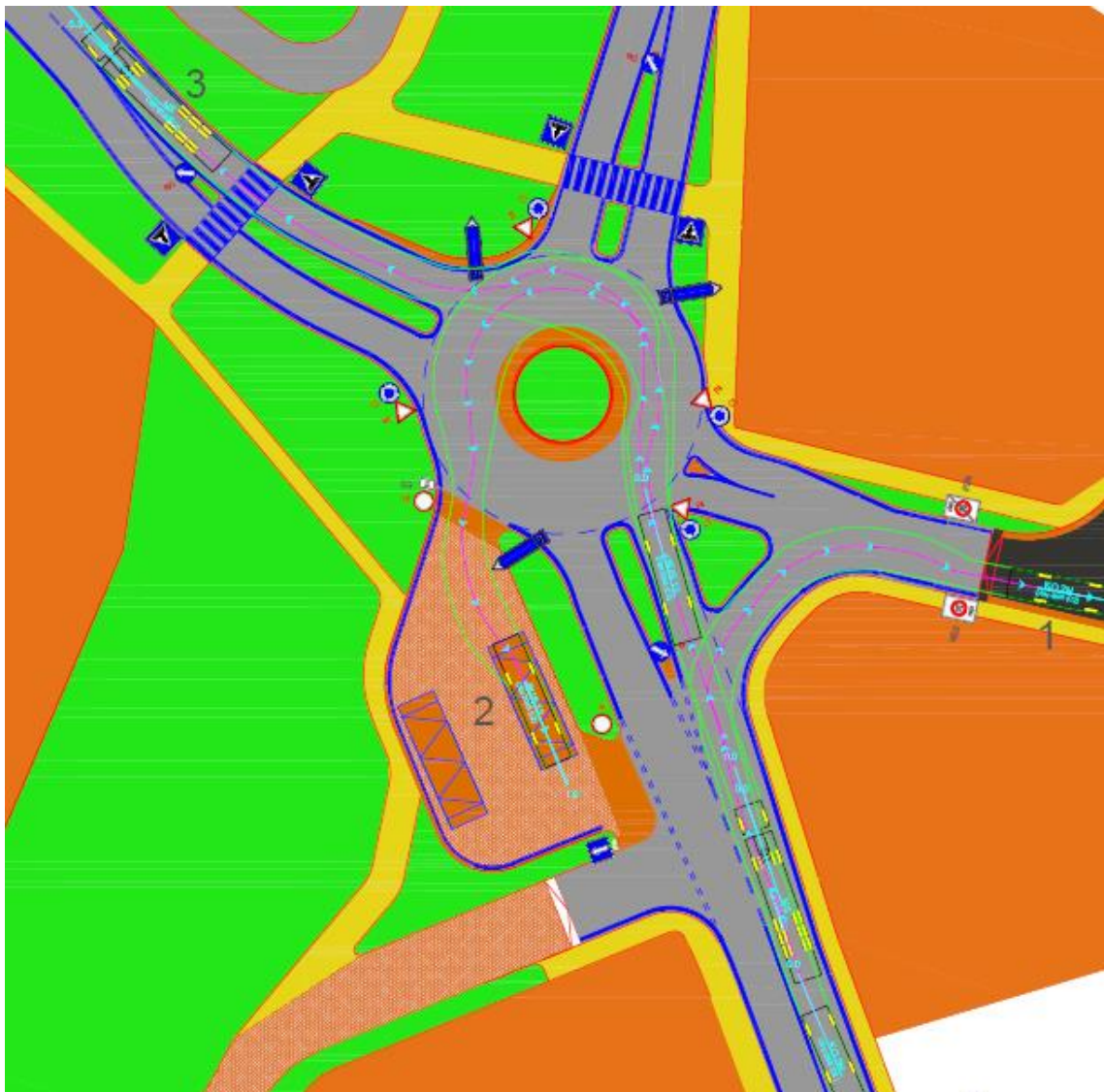
Obrázek 19 – průjezdy typů vozidel křižovatkou zdroj: Autor (pomocí programu AutoTURN)
