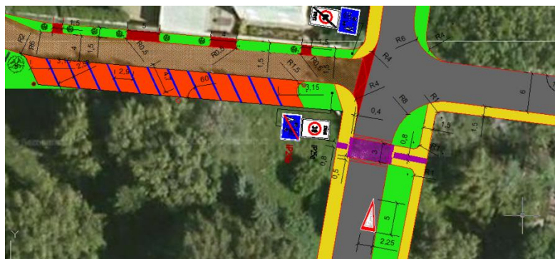
Obrázek 24 – Schéma zóny 30 v místě křížení ulic „U Špýcharu, Revoluční a U Rybníka“ zdroj: Autor (pomocí programu AutoCad)
