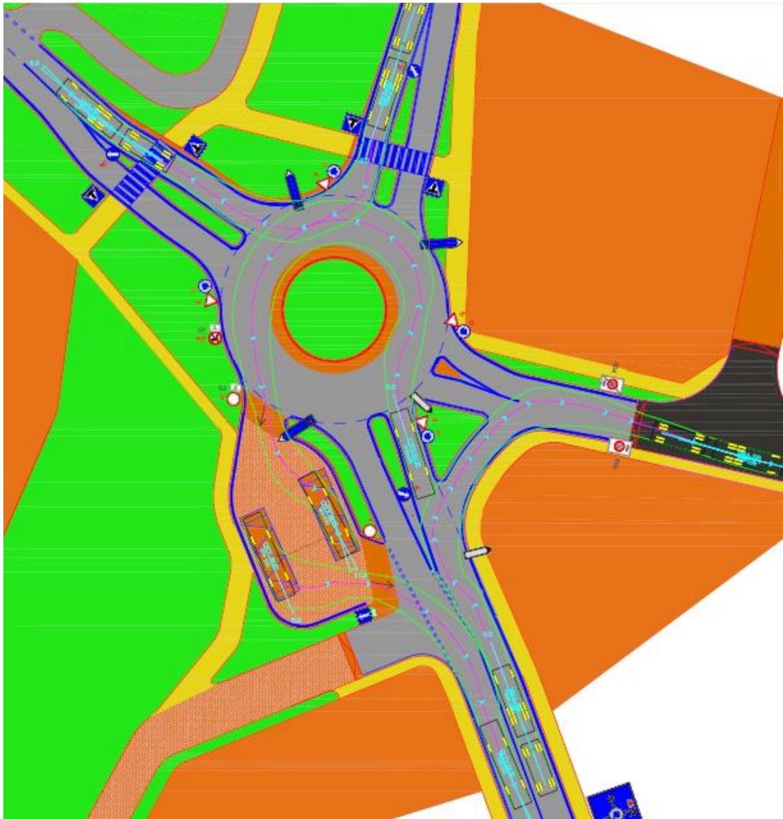
Obrázek 18 – obalové křivky varianta 3 zdroj: Autor (pomocí programu AutoTURN)
