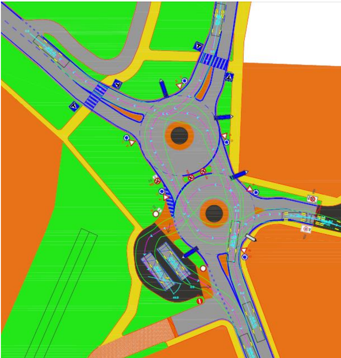
Obrázek 17 – průjezdy vozidel v návrhu 2 zdroj: Autor (pomocí programu AutoTurn)
