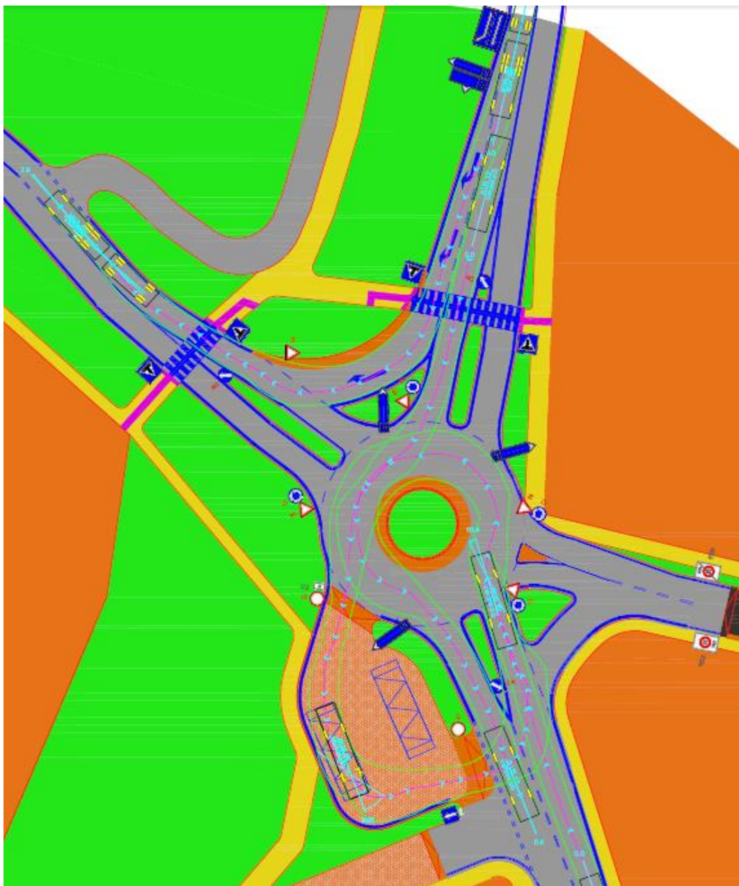
Obrázek 21 – Průjezdy vybraných typů vozidel křižovatkou zdroj: Autor (pomocí programu AutoTURN)
