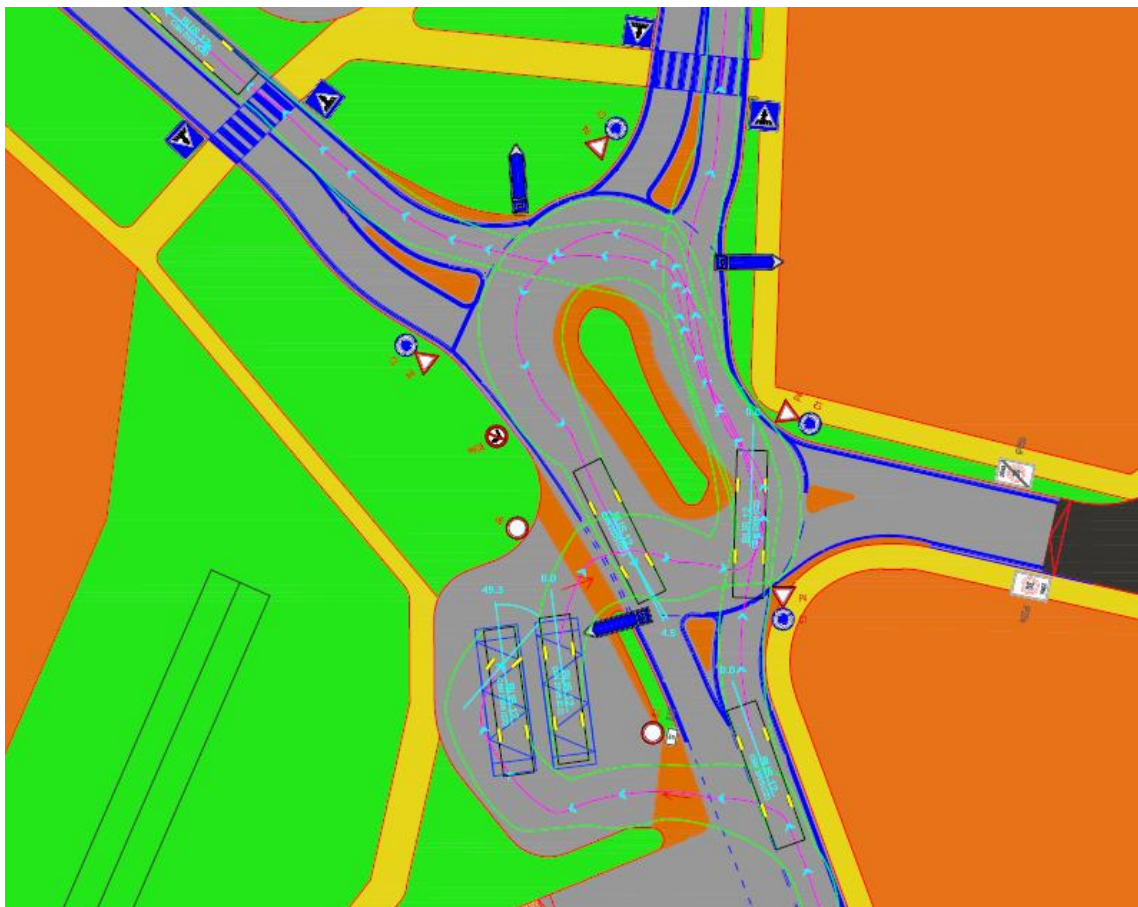
Obrázek 16 – Návrh křižovatky 1 – obalové křivky pro bus (12m) zdroj: Autor (pomocí programu AutoTurn)
