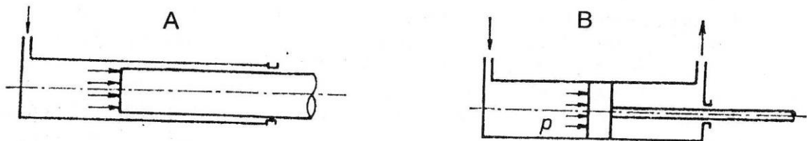
Obr. 25 Schéma jednočinného (A) a dvojčinného (B) pracovního válce s přímočarým pohybem [6]
