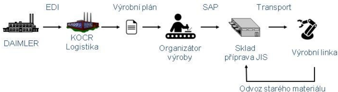
Obrázek č. 33. Schéma způsobu zásobování systémem JIS na výrobní linku; zdroj: [Autor]
