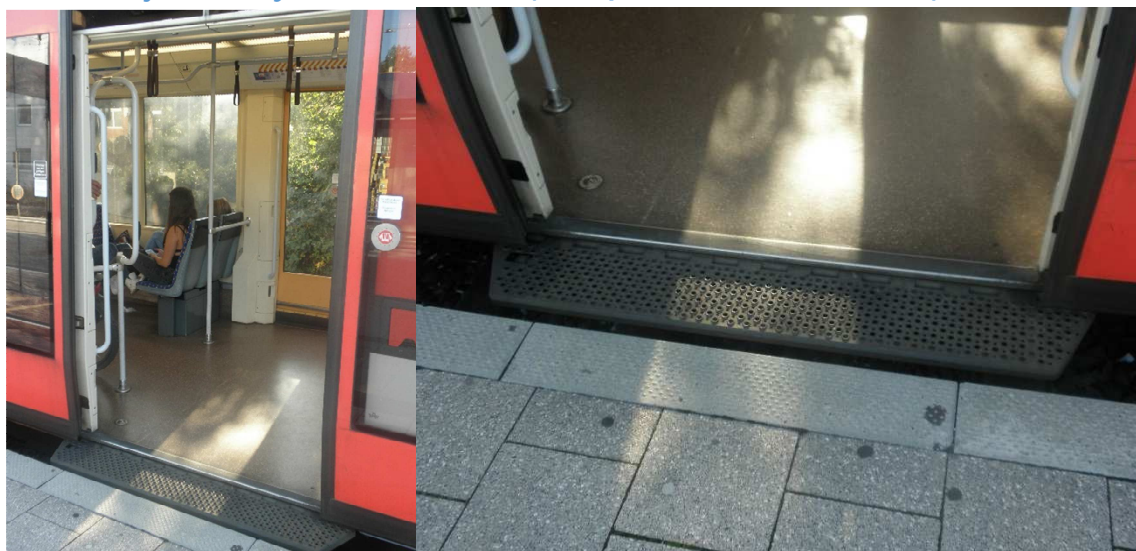
Obrázek 6: Úroňový nástup do vozidla TT v extravilánovém úseku vlakotramvajové linky v Saarbrücken (nástupní hrana 350 mm nad TK)
