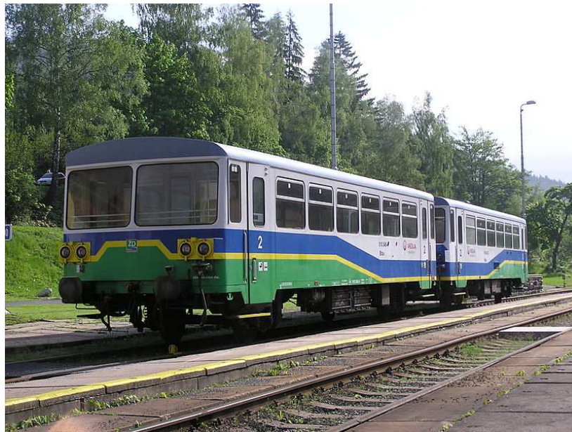
Obrázek 2: Přípojný vůz řady 010 ve stanici Kouty nad Děsnou – ukázka nevyhovující výšky nástupní hrany (cca 200 mm nad TK)
