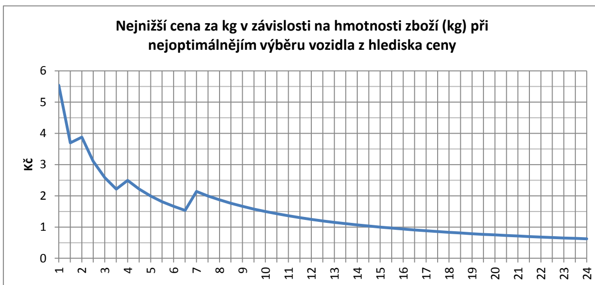
Obrázek 24. Nejnižší cena za kg v závislosti na hmotnosti zboží (kg) při neoptimálnějším výběru vozidla z hlediska. (Zdroj: autor)
