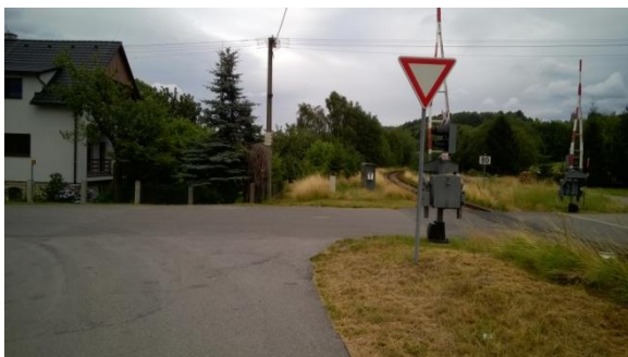
Obr.31 a 32: Výstražník není viditelný z vedlejších komunikací (zdroj: foto autora)
