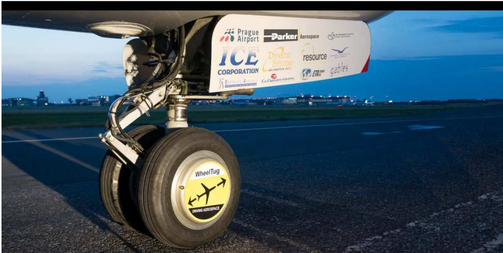
Obrázok 19: Elektromotor systému WheelTug na prednom podvozku lietadla [33]
