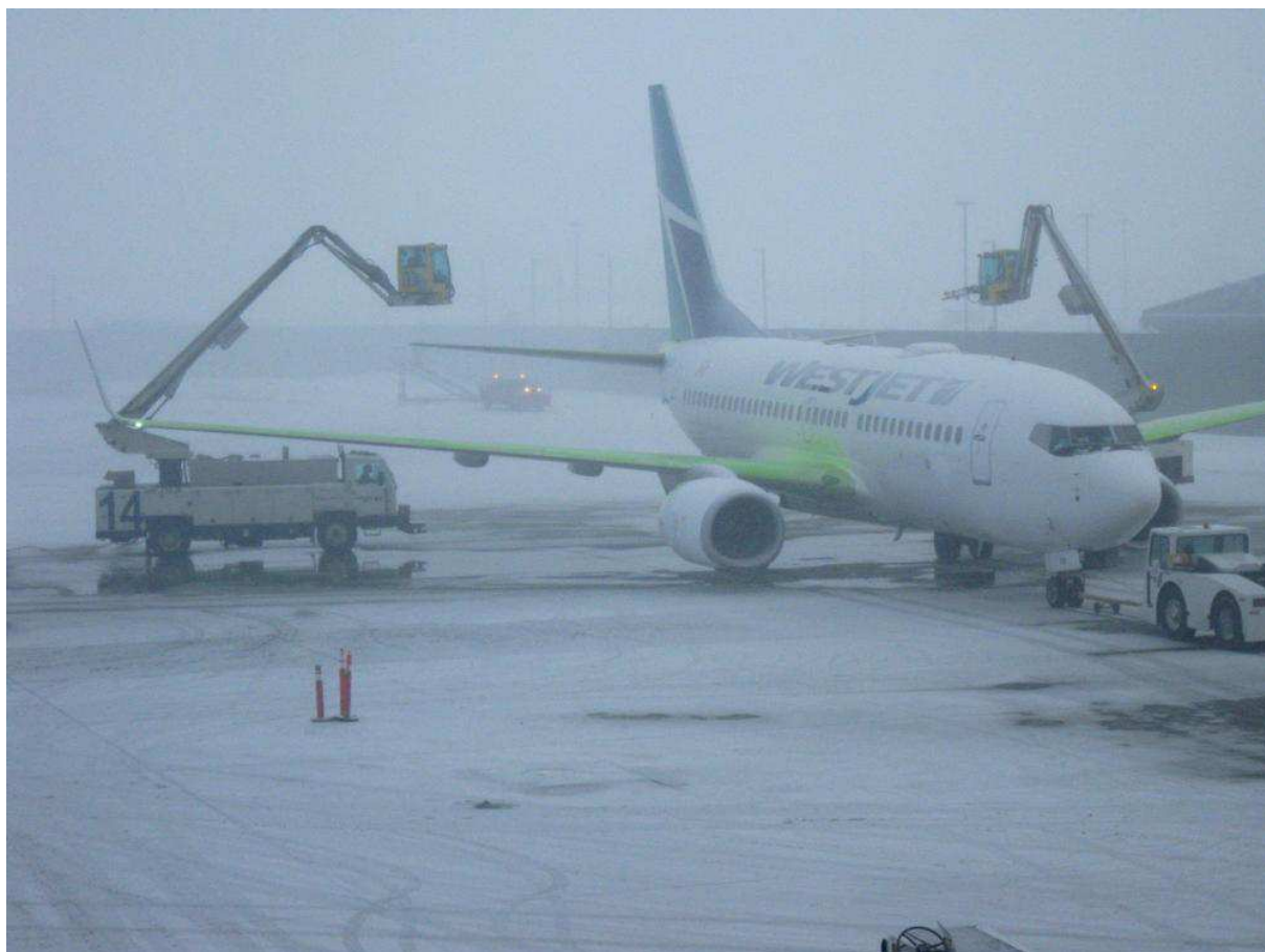
Obrázok 20: Protinámrazové ošetrovanie lietadla na letisku Calgary [34]
