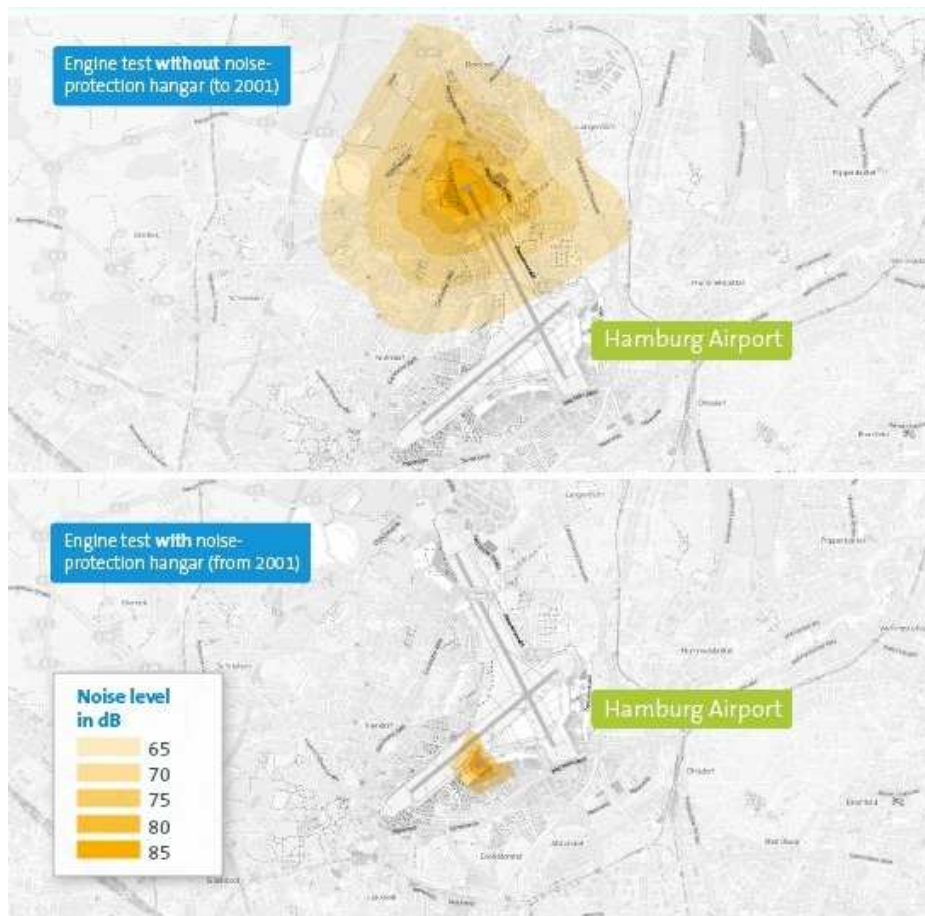
Obrázok 18: Porovnanie hluku z motorových skúšok bez/s odhlučneným hangárom, letisko Hamburg [32]
