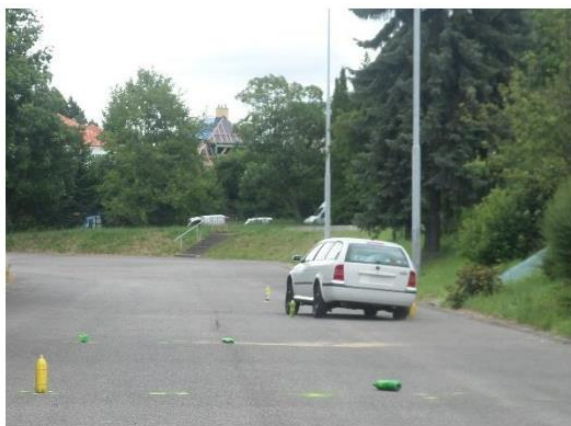
Obr. 17 Odezva na impulsní natočení volantu [3]
