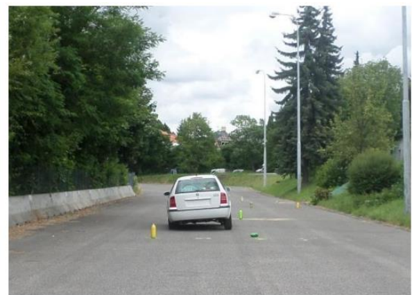
Obr. 17 Odezva na impulsní natočení volantu [3]
