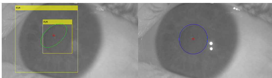
Obrázek 6.10. Špatně vepsaná elipsa. (Porovnání kaskádního detektoru s referencí Eye-Gaze SDK. Vlevo Kaskádní detektor, žlutě nalezené oblasti detektorem, zeleně finální zornice. Vpravo referenční detekce modře. Středů detekovaných zornic červeně.)
